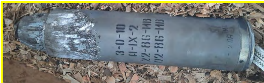
O-10 / 3-O-10 Довжина: 300 мм Діаметр: 65 мм Країна походження : РФ
