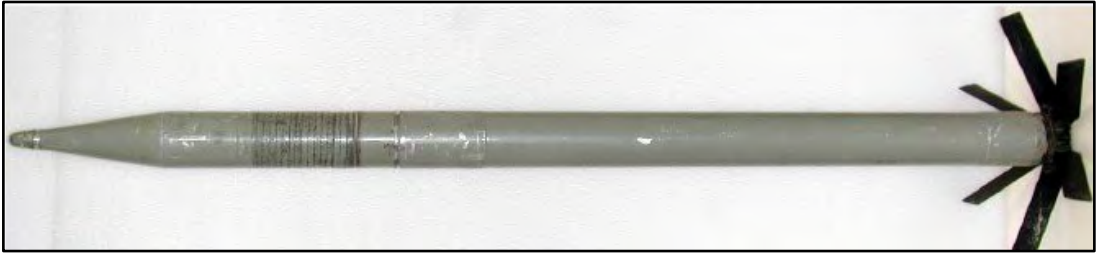
80 мм ракета серії С-8 Довжина з підривником: різна Країна походження: СРСР
