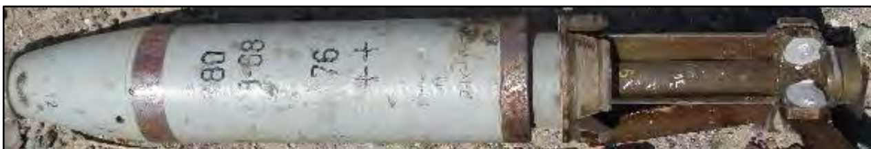
76 мм кумулятивний необертальний снаряд БК-354М
