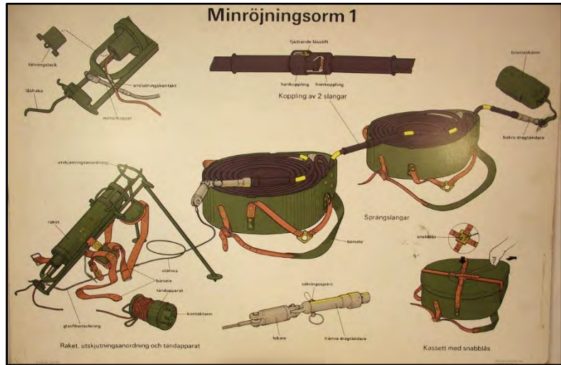
Установка розмінування «Minröjningsorm-1» Країна походження : Швеція
