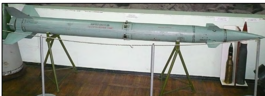
9M33 ЗРК "ОСА" Діаметр: 206 мм Довжина: 3158 мм Країна походження: СРСР
