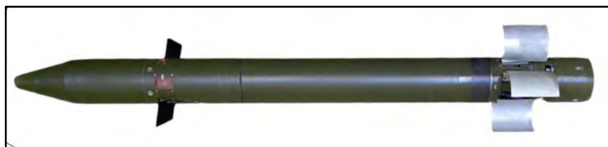
9M120Ф «Атака» Діаметр: 130 мм Довжина: 1830 мм Країна походження: РФ
