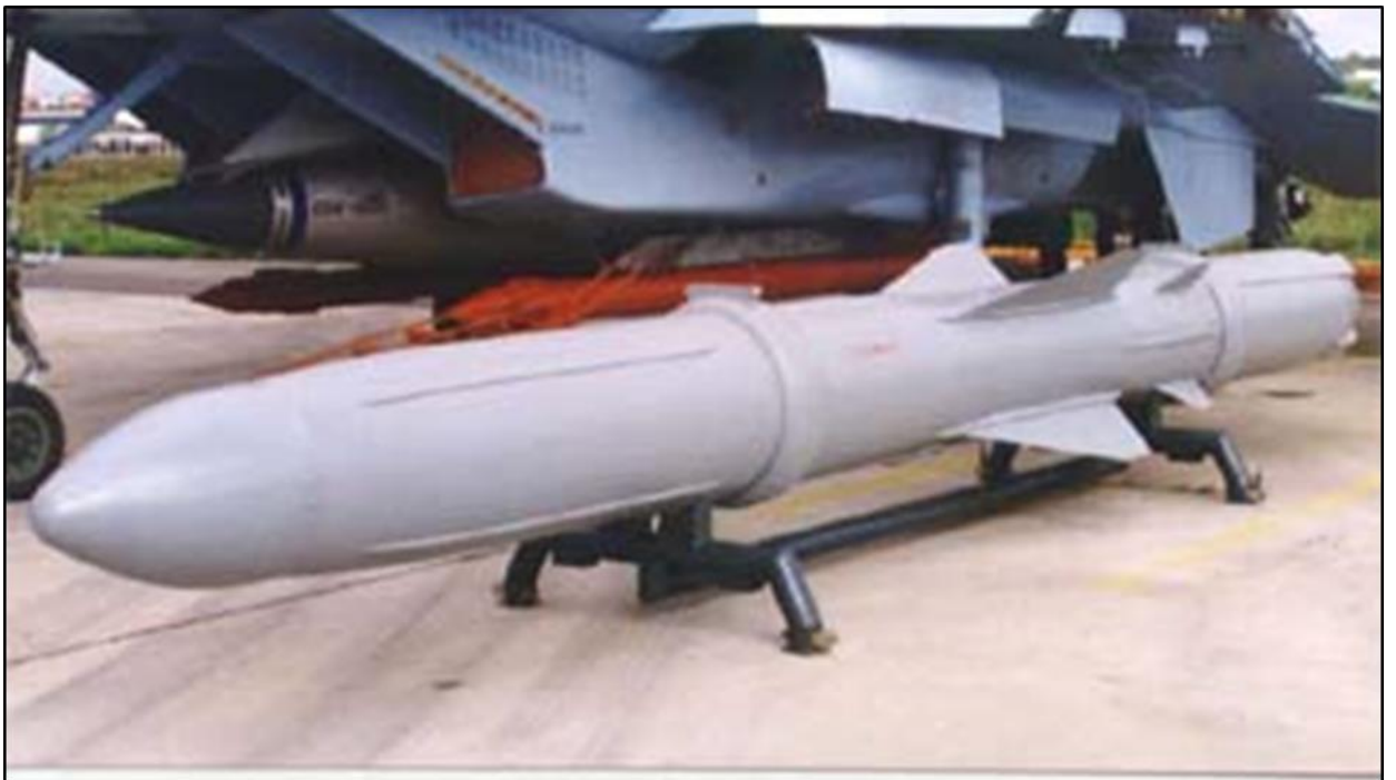
Ракета Х-61 - Версія «воздух-земля» з повітряним запуском.
