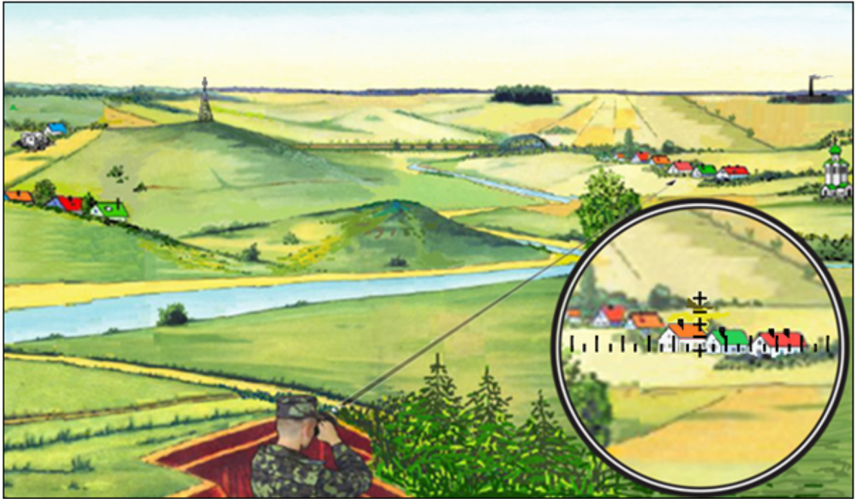
Рисунок 12 – визначення відстані за шкалою бінокля.
