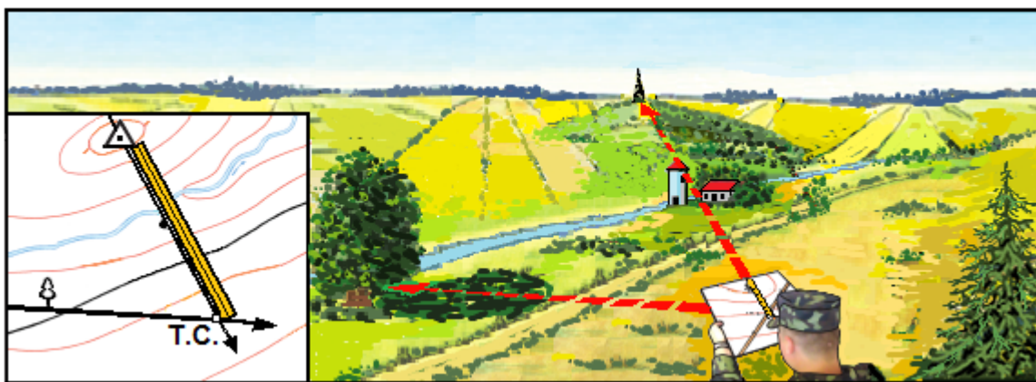
Рисунок 95 – визначення точки стояння за створом і боковим орієнтиром.
