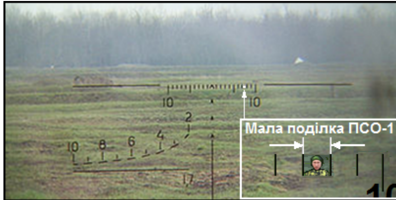
Рисунок 13 – визначення відстані за шкалою ПСО-1.
