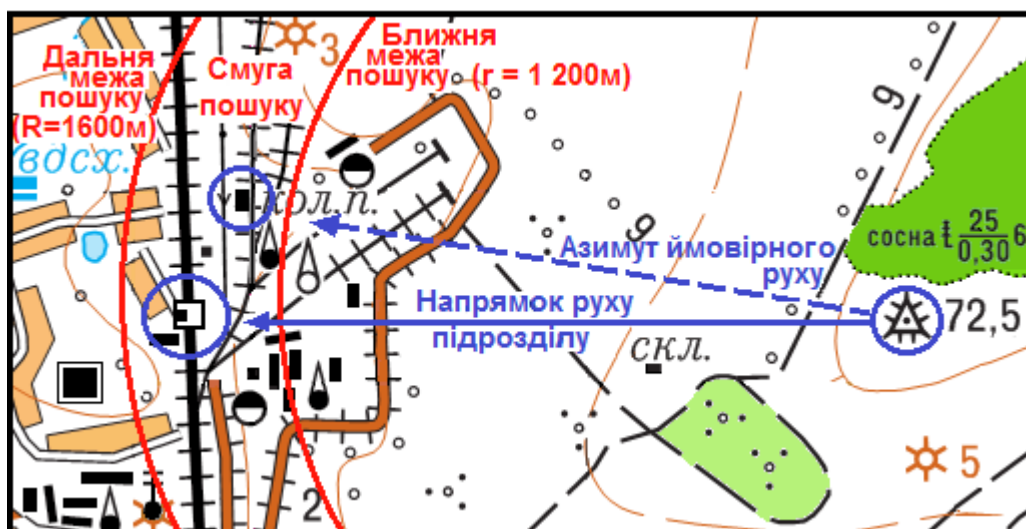
Рисунок 104 – відновлення орієнтування графічним способом.
