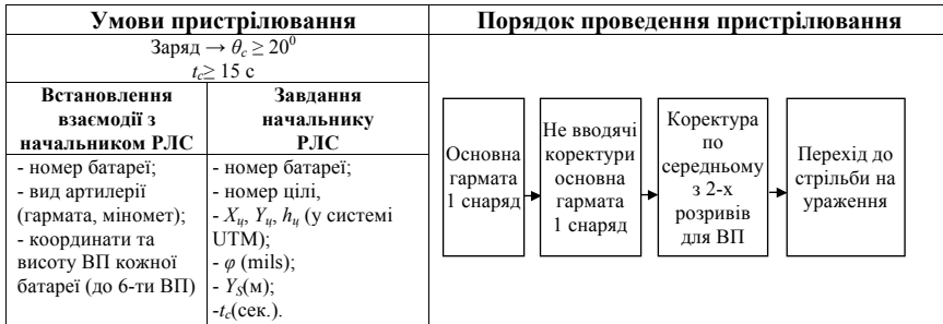
Рисунок8 – Загальний порядок пристрілювання за допомогою РЛС типу AN/TRQ
