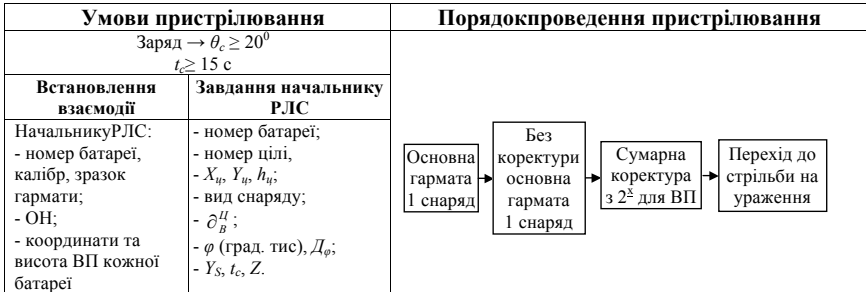
Рисунок 7 – Загальний порядок пристрілювання за допомогою РЛС типу АРК
