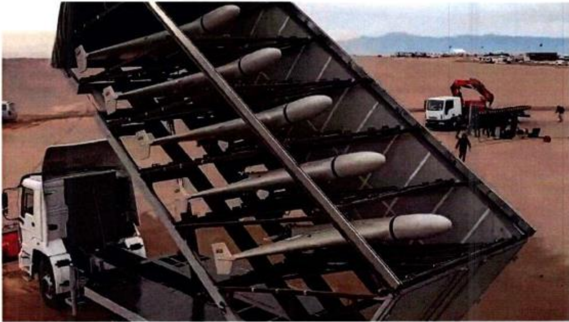
Рисунок 1.3 – Пускова установка БпЛА “Shahed 136”, замаскована під самоскид
