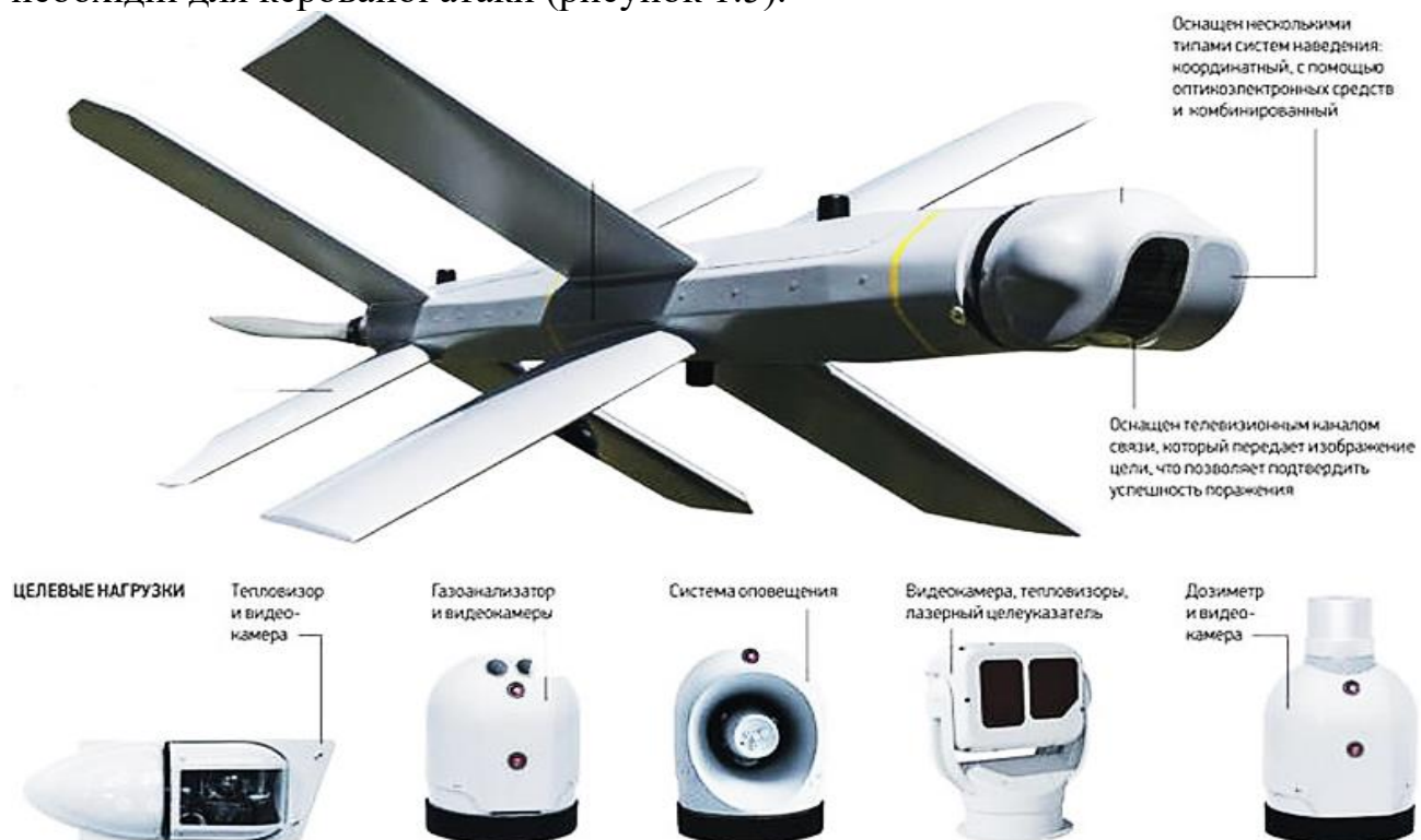
Рисунок 1.5 – Оснащені декількома типами систем наведення та комбінованим телевізійним каналом зв'язку
