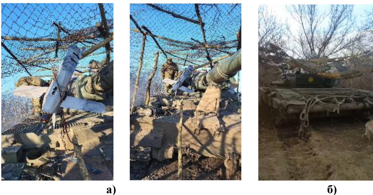
Рисунок 3.6 – Приклад використання металевих сіток у якості захисних екранів підрозділами артилерії (а) та танковими підрозділами (б)
