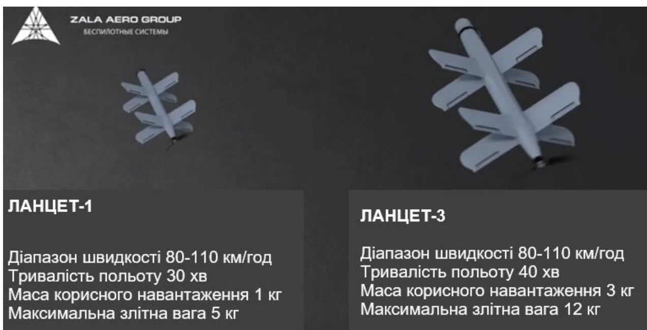
Рисунок 1.4 – Характеристики ударних БпЛА “Ланцет - 1” і “Ланцет - 3”
