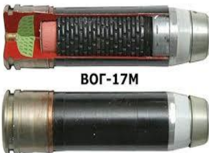
Рисунок 1.2 – загальний вигляд пострілу зі скалковою гранатою до АГС-17 ВОГ-17М.
