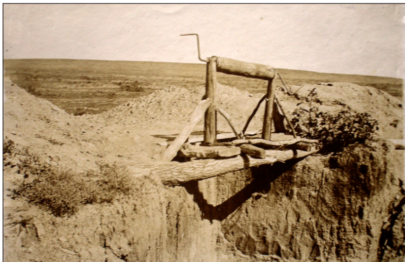
Рис. 1. «Вороток» для підйому накопаної глини. Кол. Слов'яносербський повіт Катеринославської губернії.
