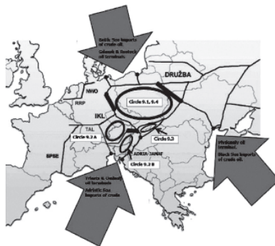
Rys. 5. Rysunek 5 pokazuje możliwe kierunki dostaw ropy naftowej do krajów regionu Europy Środkowo Wschodniej i integrację ich rynków ropy poprzez zbudowanie sieci połączeń rurociągów. 3
