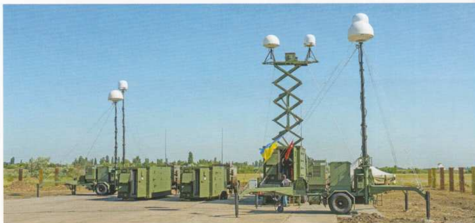
Drugi ukraiński system TB2 należy do wersji zmodernizowanej. Poza różnicami w ukończeniu aparatu (trójłopatowe śmigło, dostosowanie do montażu stacji radiolokacyjnej SAR itp.), zmieniono także zestaw wyposażenia naziemnego. Oprócz trzech naziemnych stacji kontroli w jego skład wchodzi także dodatkowe stacje retranslacyjne (na pierwszym planie po prawej i w głębi po lewej) podwajające zasięg łączności i transmisji danych.
