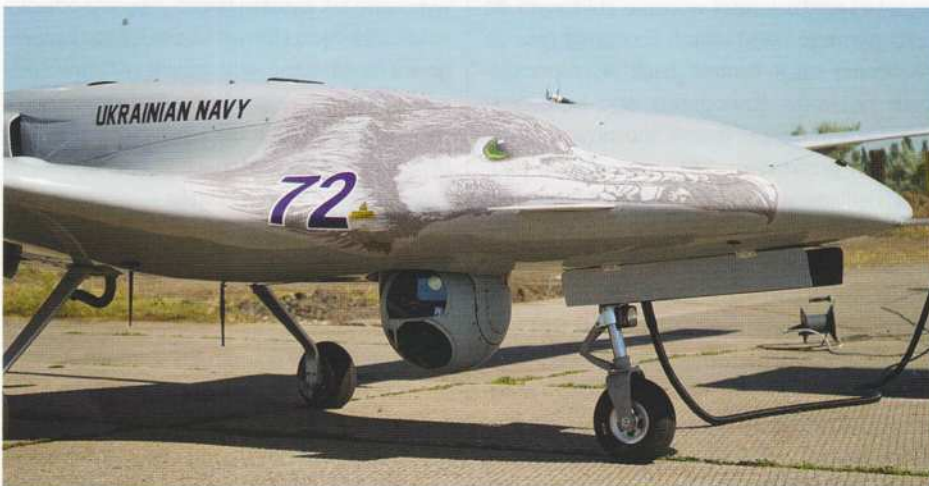
Zbliżenie na przednią część ukraińskiego „morskigo” aparatu TB2. Doskonale widoczna głowa albatrosa na kadłubie, a także głowica optoelektroniczna L3Harris WESCAM CMX-15D.
