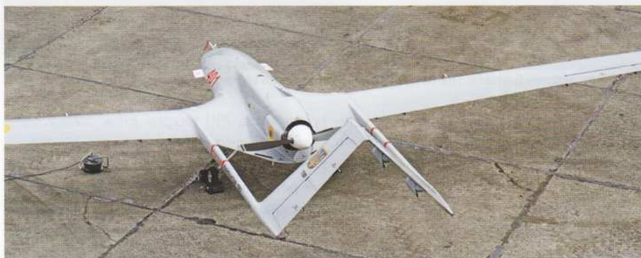
Ukraiński TB2 od tyłu. Dobrze widoczna osłona silnika tłokowego Rotax 912iS napędzającego dwulopatowe śmigło pchające. Widoczne oznaczenia przynależności państwowej na usterzeniu pionowym i osłonie silnika, a także trzycyfrowy czerwony numer taktyczny na przedniej części kadłuba.
