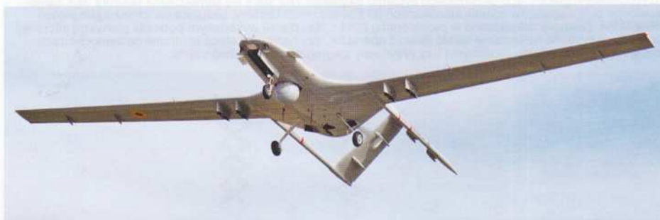
TB2 383. pułku w locie w konfiguracji gładkiej. Dobrze widoczny układ maszyny z chowanym kołem przednim i stałym podwoziem głównym, belki podwieszon pod skrzydłami i głowica optoelektroniczna pod kadłubem. Widoczne niesymetrycznie rozmieszczone oznaczenie przynależności państwowej po prawym skrzydle.
