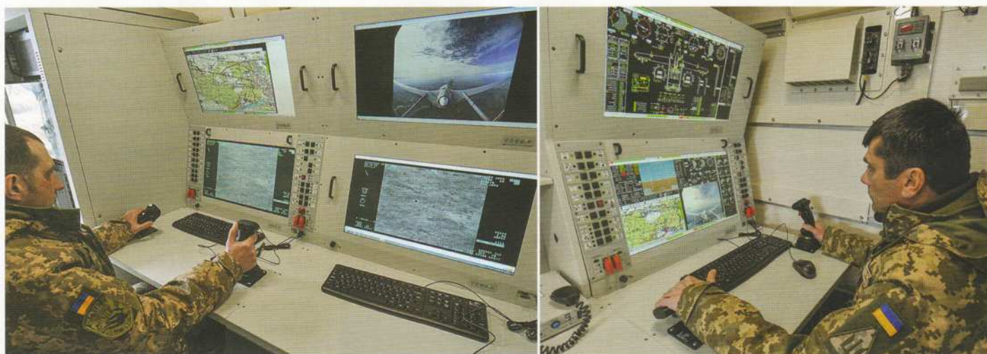
Wnętrze naziemnej stacji kontroli pierwszego ukraińskiego systemu. W uniwersalnym kontenerze umieszczono trzy stanowiska operatorskie. Sądząc z wyświetlanych na monitorach obrazów, operator na zdjęciu po lewej stronie i jego niewidoczny kolega zajmują się planowaniem misji oraz kontrolą ładunku użytecznego (w tym przypadku głowicy optoelektronicznej) i wykorzystaniem uzbrojenia. Operator na prawym zdjęciu nadzoruje stan maszyny i steruje jej lotem.
