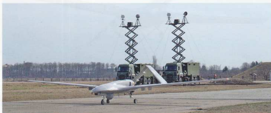
Aparat bezzałogowy Bayraktar TB2 Sił Powietrznych Sił Zbrojnych Ukrainy kołuje na start. W tle dwie naziemne stacje kontrolne.
