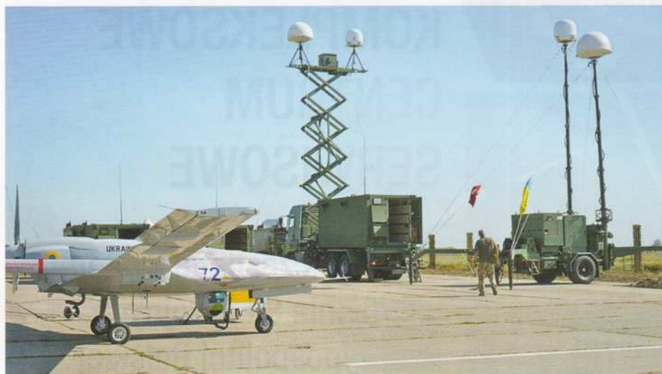
Aparat TB2 10. (Sakskiej) Brygady Lotnictwa Morskiego WMSU, naziemna stacja kontrolna w położeniu roboczym i zestaw retranslacyjny – zasadnicze elementy systemu zakupionego dla ukraińskiego lotnictwa morskiego.
