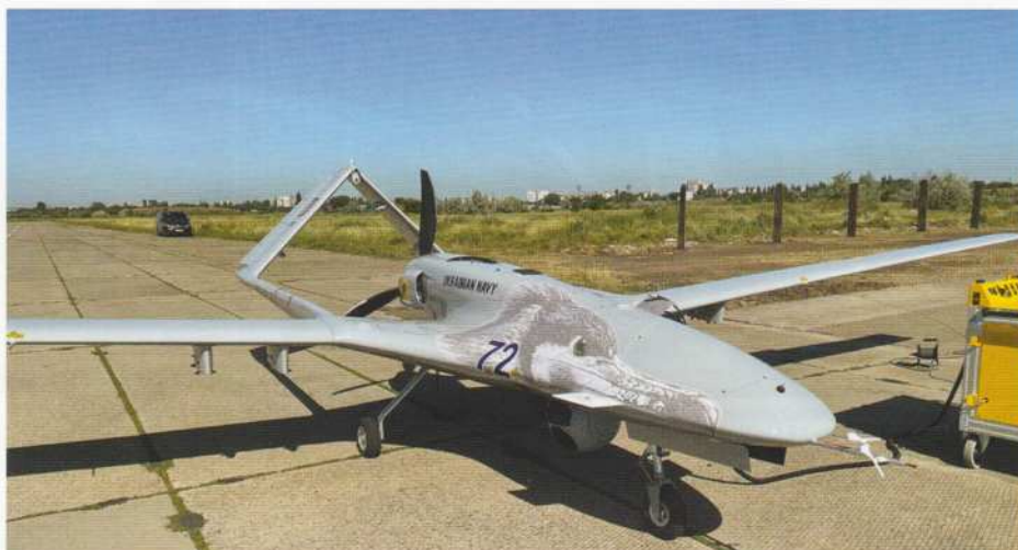
10. (Saksa) Brygada Lotnictwa Morskigo WMSU bazuje na lotnisku Mikołajów-Kulbakino, które jest macierzystą bazą także samodzielnej eskadry Bayraktarów Sił Powietrznych ZSU. Z pewnością upraszcza to szkolenie i logistykę. Bezałogowiec na zdjęciu jest podłączony do aparatury kontrolno-zasilająco-rozruchowej.
