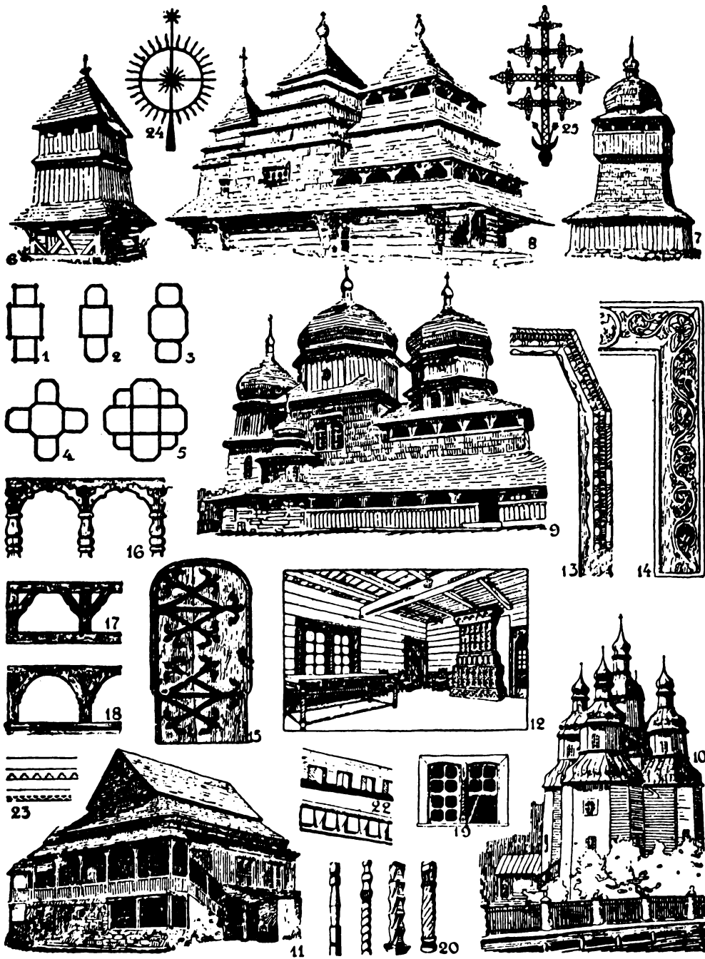
1-5 — типи плянів дерев'яних церков (тризрубні, п'ятизрубні і дев'ятизрубні; 6 — звичайний тип вежі дзвіниці, Потиліччя 1731 р.; 7 — вежа-дзвіниця з баню, Львів; 8 — бойківська церква, с. Турка 1760 р.; 9 — церква св. Юра в Дрогобичі бл. 1600 р.; 10 — п'ятибанна церква в Ромні 1784 р.; 11 — синагога в Яришеві XVIII ст.; 12 — будинок Галагана в Лебединцях 1884 р.; 13-14 — різьблені одвірки (Київщина й Полтавщина); 15 — оковані двері, Потиліччя XVI ст.; 16 — деталь опасання, Іски в Карпатах 1798 р.; 17-18 — «голосник» й галерійки (деталь); 19 — подвійне вікно будинку Галагана в Лебединцях, 20 — типи різьблених сох; 21-23 — різьба з балків сволоків; 24 — «снисячник» — залізне закінчення вежі, будинків, дзвіниць; 25 — залізний хрест
