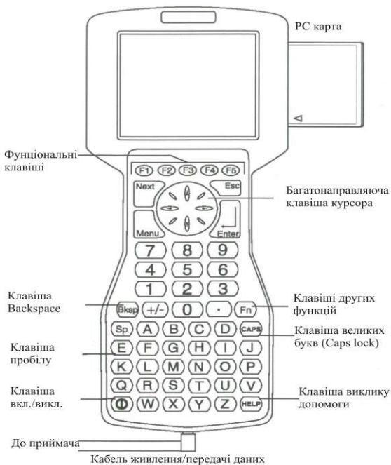
Рис. 17.1. Контролер TSC-1: вигляд зі сторони дисплею
