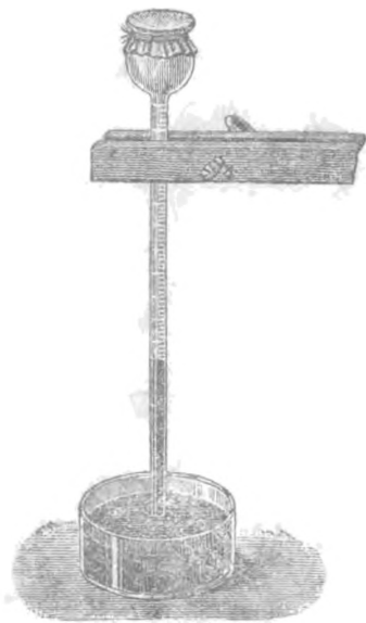
Мал. 48. Як набирається живе срібло з посуду в трубку, бо з неї, крізь болонку, випаровується вода.
