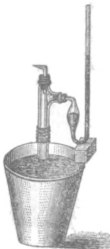
Мал. 44. Як вимірюють силу „плачу рослини“.
