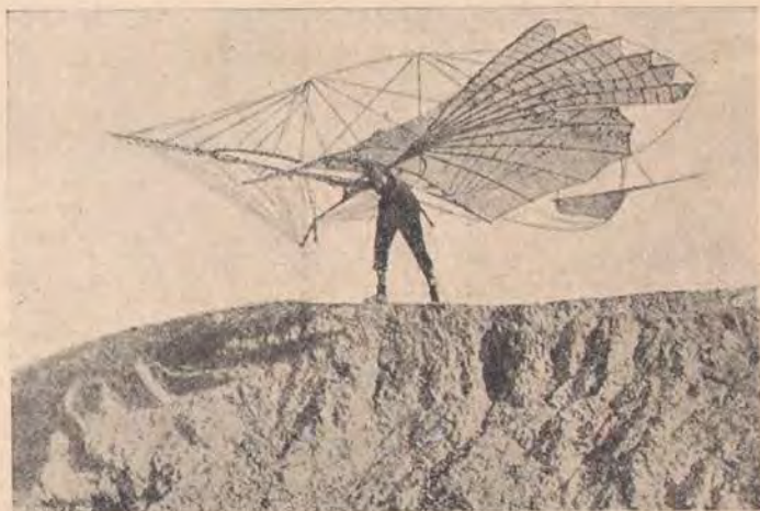
Один з апаратів Отто Лілієнтала. Кінці крил можуть махати за допомогою особливого приладдя, зробленого Лілієнталем.
