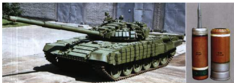
Рис. 9.6.3. Підкалібровий постріл для 100-мм протитанкової гармати МТ-12
