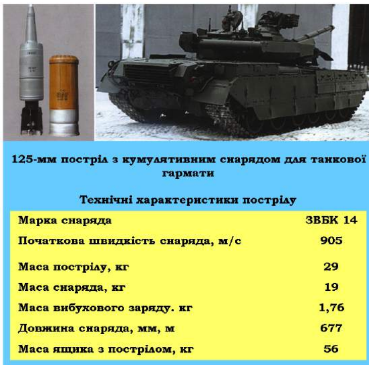
Рис. 9.6.5. Кумулятивний постріл для 125-мм танкової гармати
