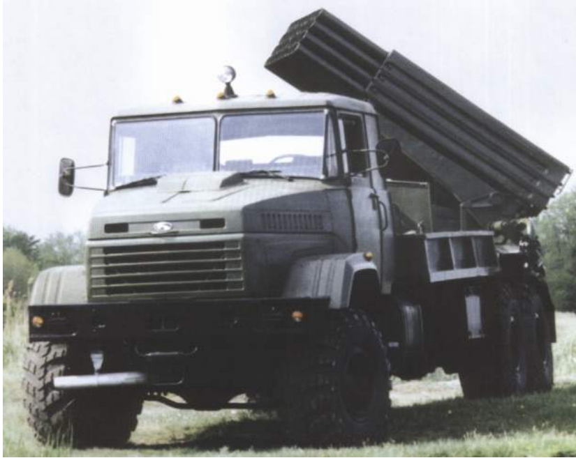
Рис. 9.3.11. Реактивна артилерійська установка БМ-21 9К51 "Град"
