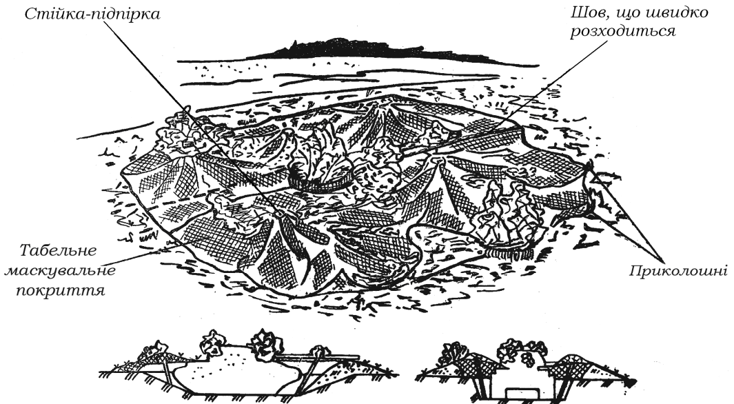
Рис. 13.3.1. Маскування броньованої техніки в окопі під фон місцевості (варіант)
