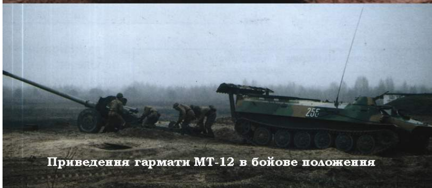
Рис. 9.4.14. Протитанкова гармата МТ-12 калібру 100-мм, тягач МТАБ на вогневій позиції
