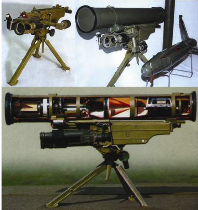
Рис. 2.2.9. Протитанковий ракетний комплекс (ПТРК) типу 9К115 "Метис" (пускова установка 9П151, транспортний пусковий контейнер на ПУ, протитанкова керована ракета 9М113)
