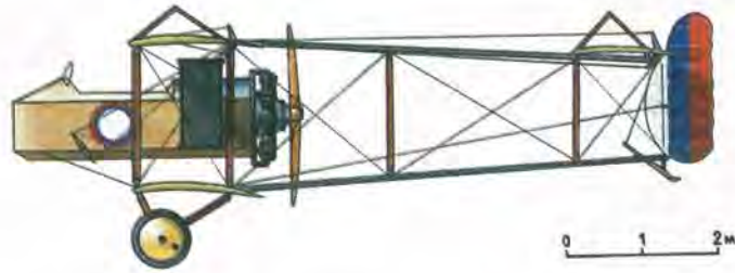
Двомісний біплан-розвідувач зі штовхальним гвинтом „Farman F-30” – „Фарман Ф-30” – „Фарсаль”). Російське військове означення: триколірні кокарди зверху і знизу на крилах, бортах кабіни, горизонтальному хвостовому оперенні, триколірне стерно повертіє. Харківський авіадивізіон. 1918 р.
