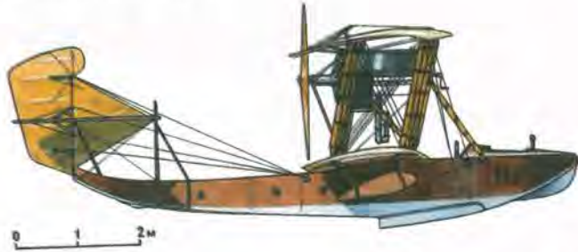
Двомісний гідролітак (летючий човен) Д. Григоровича М-9. Російське військове означення: триколірні кокарди зверху і знизу на крилах. На носі кабіни чорний номер 155. Авіація Чорноморської флотії. Штаб повітряної дивізії. Севастополь. 1918 р.
