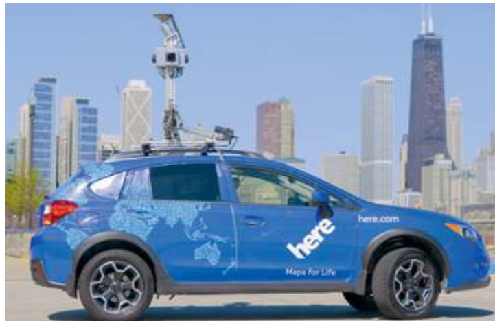
Селфі з містом. Автомобіль-картограф Джордж від компанії HERE збирає найменші деталі про дороги міста. З них формуються HD-мапи для навігації машин без водіїв
