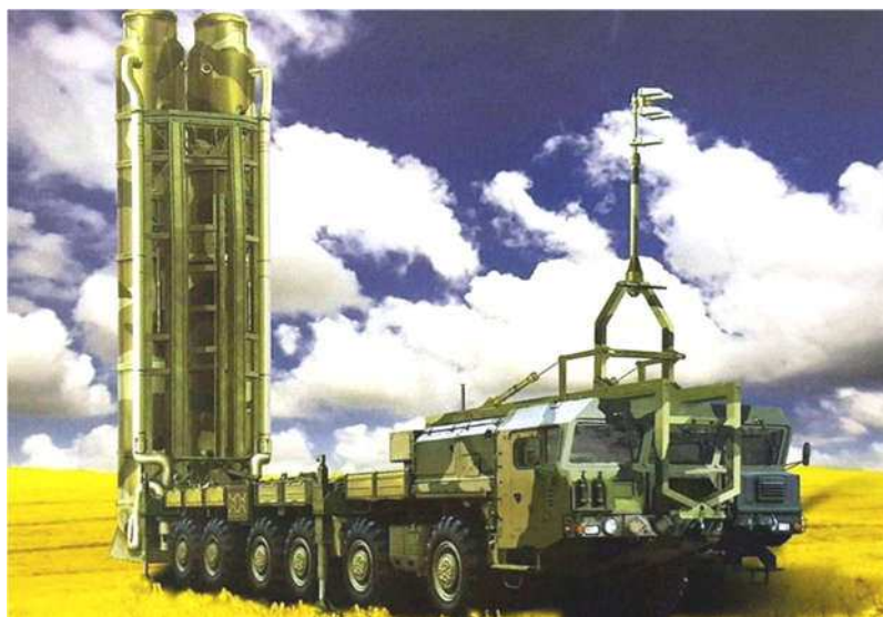
Рис. 2.155 – ПУ 77П6 із протиракетами 77Н6 в ТПК
