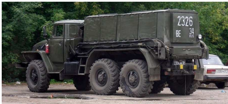
Рис. 2.114 – Зовнішній вигляд аеродромного рухомого електроагрегату АПА-100
