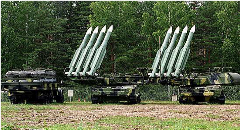
Рис. 1.109 – Елементи ЗРК “Бук-М1” (транспортна машина, пускозаряджальна та самохідна вогнева установки)
