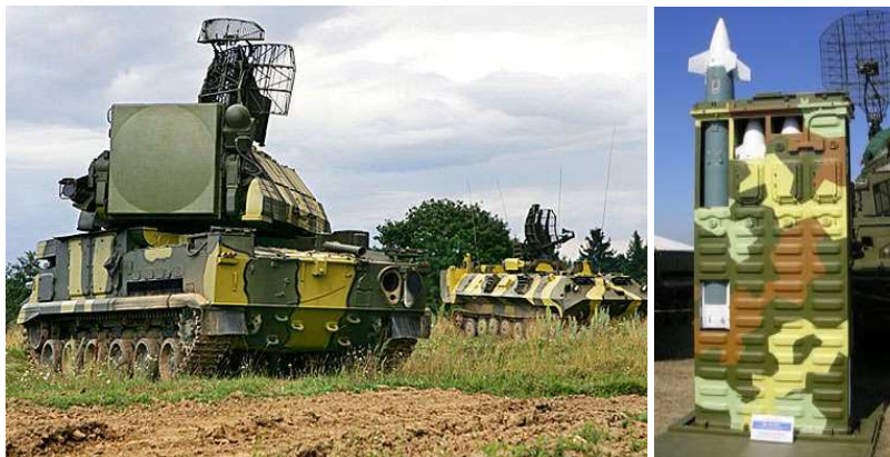
Рис. 1.106 – Елементи ЗРС “Тор-М1” (бойова машина 9А331, станція виявлення та ЗКР 9М331)
