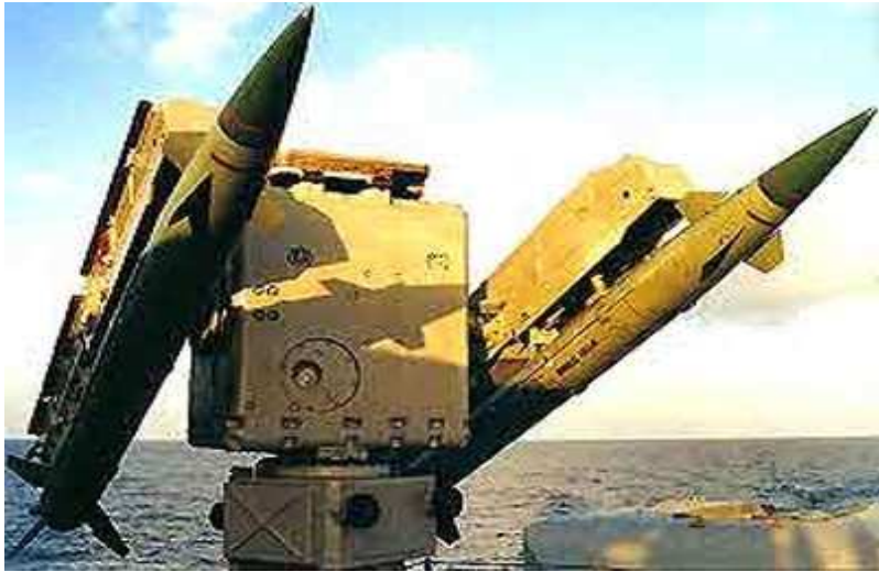
Рис. 3.67 – Пусковий пристрій ЗРК “Оса-М” з двома ЗКР 9М33
