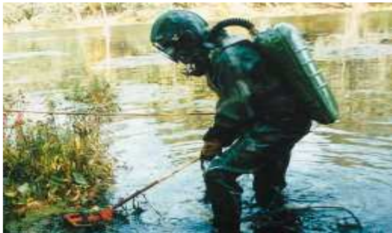
Рис. 1.152 – Зовнішній вигляд водозалізного міношукача МІВ-2
