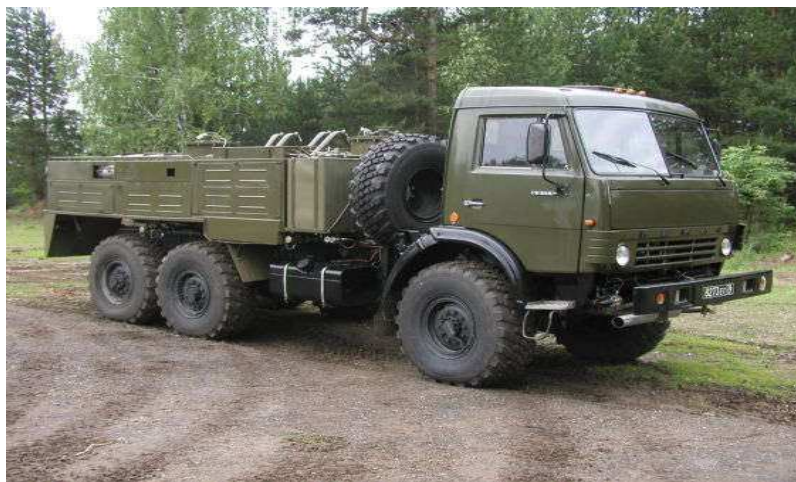
Рис. 1.190 – Авторозливальна станція АРС-14КМ
