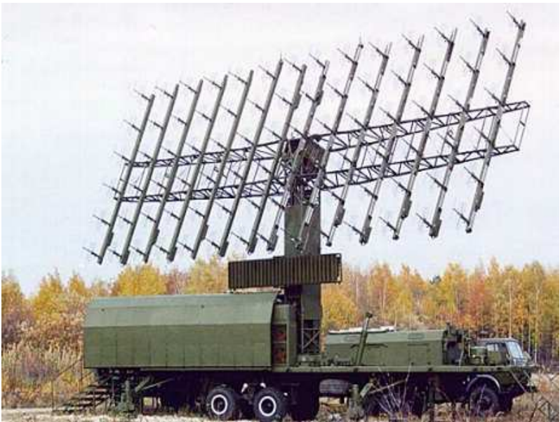
Рис. 2.190 – РЛС “Небо-СВУ” в розгорнутому стані
