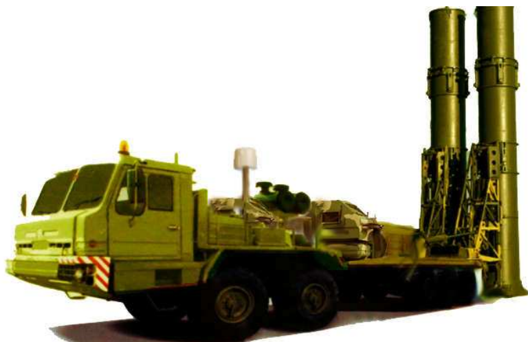
Рис. 2.154 – ПУ 51П6М з ракетами 40Н6М в ТПК
