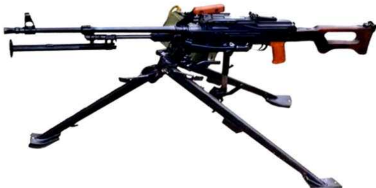
Рис. 7.18 – 7,62-мм модернізований кулемет Калашникова ПКМ на станку 6Т5
