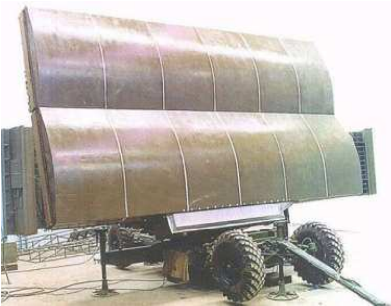
Рис. 2.182 – РЛС “Гамма-Д” з її антенно-поворотним пристроєм у розгорнутому стані
