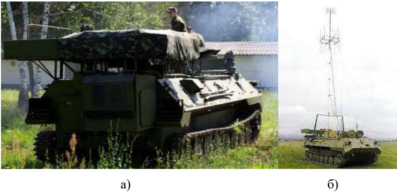
Рис. 6.7 – АСП УКХ радіозв'язку Р-330Б: а) – у похідному положенні; б) – у бойовому положенні
