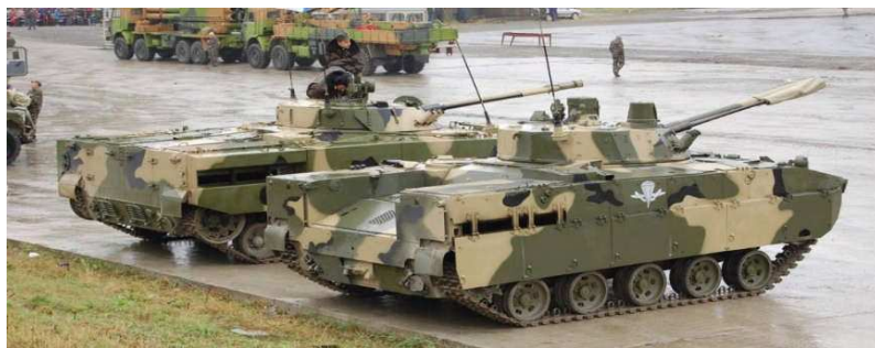
Рис. 5.9 – Різниця в компонованні десантного відділення в бойовій машині десанту БМД-4М (ліворуч) та БМД-4 (праворуч, класична для всіх попередніх версій БМД та БТР-Д)
