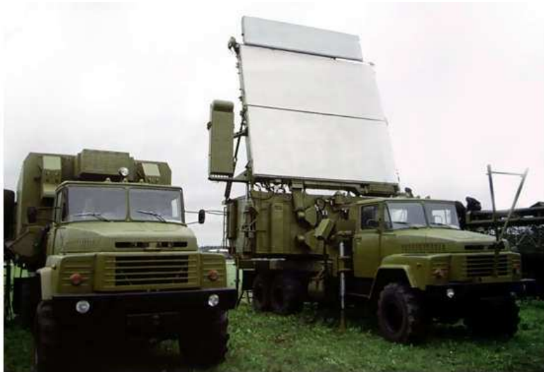
Рис. 2.183 – Машини М1 та М2 РЛС “Гамма-С1” модифікації 64Л6 (на шасі КраЗ-260)
