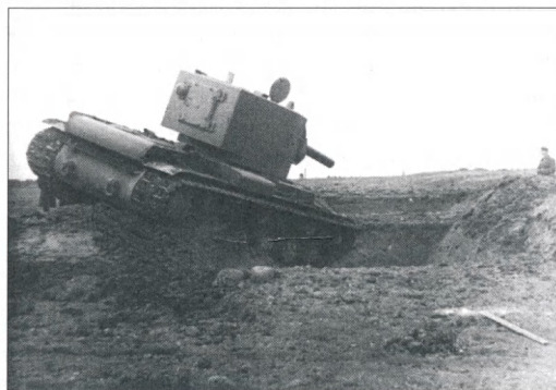
Танк KV-2 випробовується на протитанковому рові
