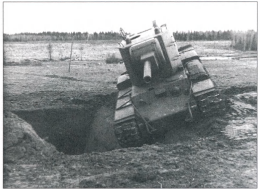
КВ-2 при спробі переїзду через протитанковий рів
