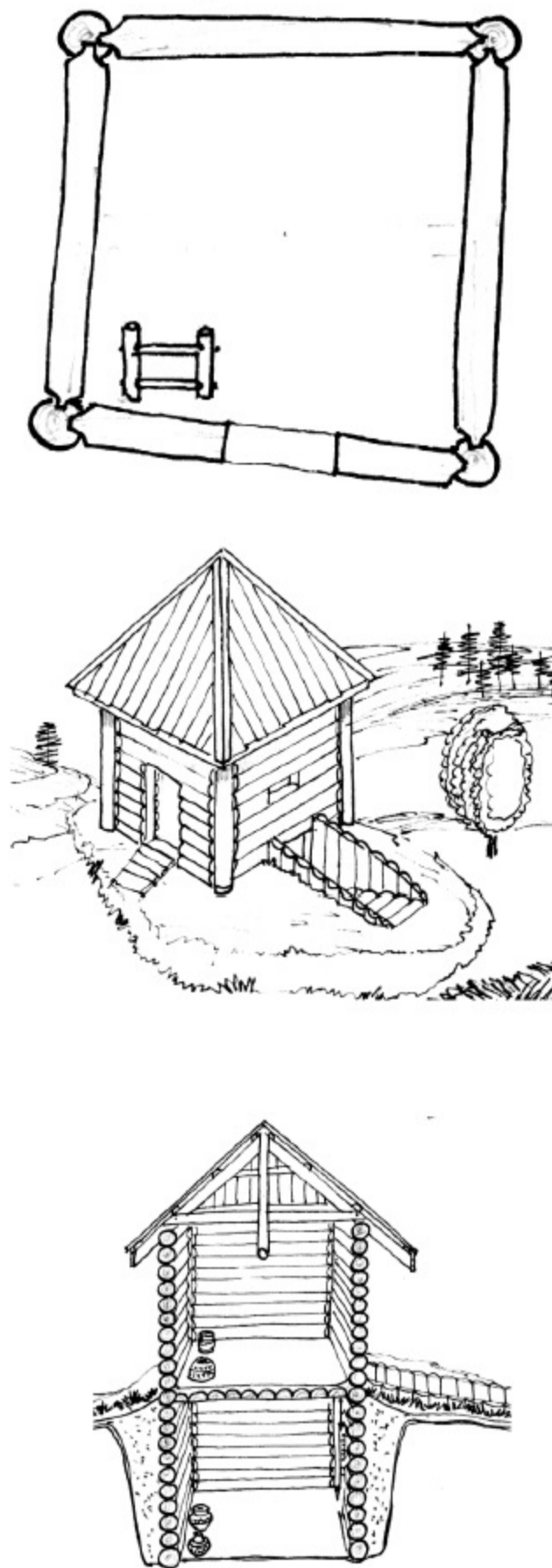
Рис. 3.33. Реконструкція двоярусного житла на холодному підкліті з Григорівки за даними археологічних досліджень.
