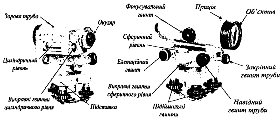
Рис. 1.2.1. Загальний вигляд нівеліра Н-3.
