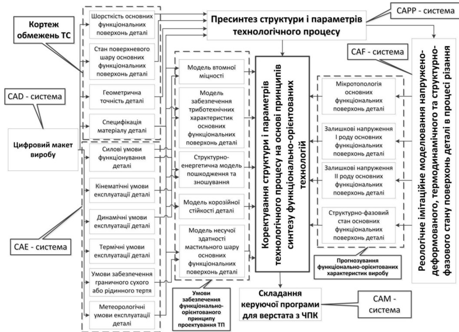
Рис.2.1. Структурно-логічна схема технологічної підготовки виробництва за функціонально-орієнтованим принципом
