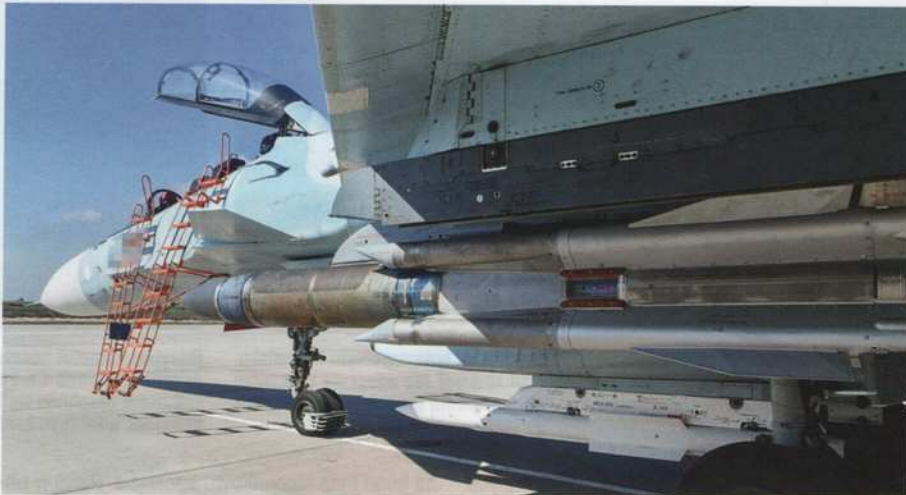
Rosyjski samolot bojowy Su-30SM z podwieszoną rakiętą Ch-31P do zwalczania radarów obrony powietrznej przeciwnika.
