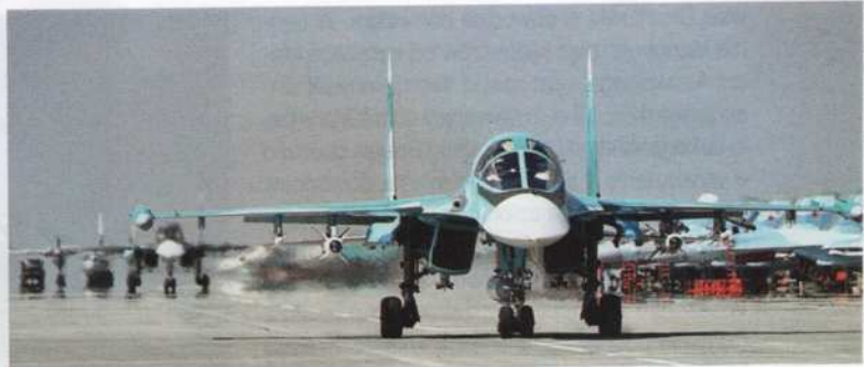
Rosyjski samolot uderzeniowy Su-34 z podwieszonymi pociskami kierowanymi powietrze-ziemia Ch-29 oraz powietrze-powietrze R-73. Na końcach skrzydeł widoczne zasobniki walki radioelektronicznej Ł-175W Chibiny , a pod kadłubem kontener WRE typu Ł-700 Tarantul .
