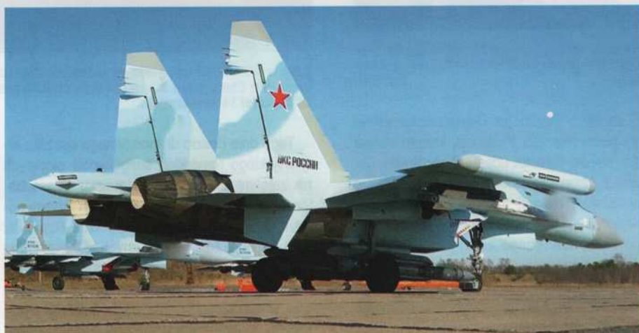
Wielozadaniowy samolot bojowy Su-35S w konfiguracji do przełamania obrony przeciwlotniczej. Na podwieszonych pod wlotami powietrza widoczne są pociski przeciwradiolokacyjne Ch-31P. Na końcówkach skrzydeł widoczne zasobniki walki radioelektronicznej. W tle maszyna z bombami kierowanymi. Fot. MO Rosji
