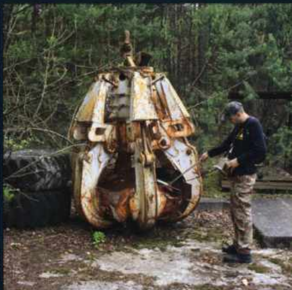
г. Припять, измерение уровня радиоактивности ковша, использовавшегося при ликвидации последствий аварии на ЧАЭС. 20 июня 2009 года
