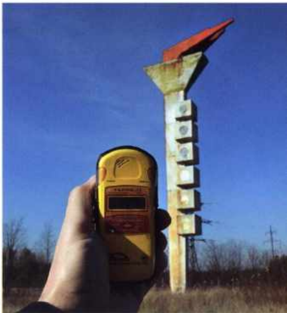
Индивидуальный бытовой дозиметр MKC-05 “Терра-П”, произведенный в Украине. Размеры 120×56×26 мм, вес 150 граммов. Питание — две батарейки ААА. Дисплей без подсветки, тип детектора — газоразрядный. При этом следует учитывать, что его показания не принимаются во внимание государственными органами вследствие большой погрешности измерения
