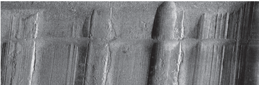
Розгортка бічної поверхні кулі, отримана шляхом лазерного сканування за допомогою балістичної системи «Рикошет»
