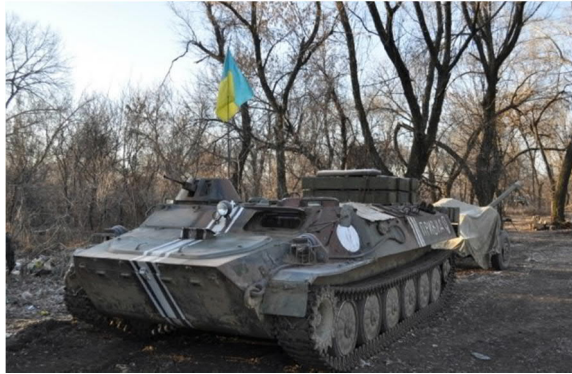
Тягач МТ-ЛБ з протитанковою гарматою МТ-12
