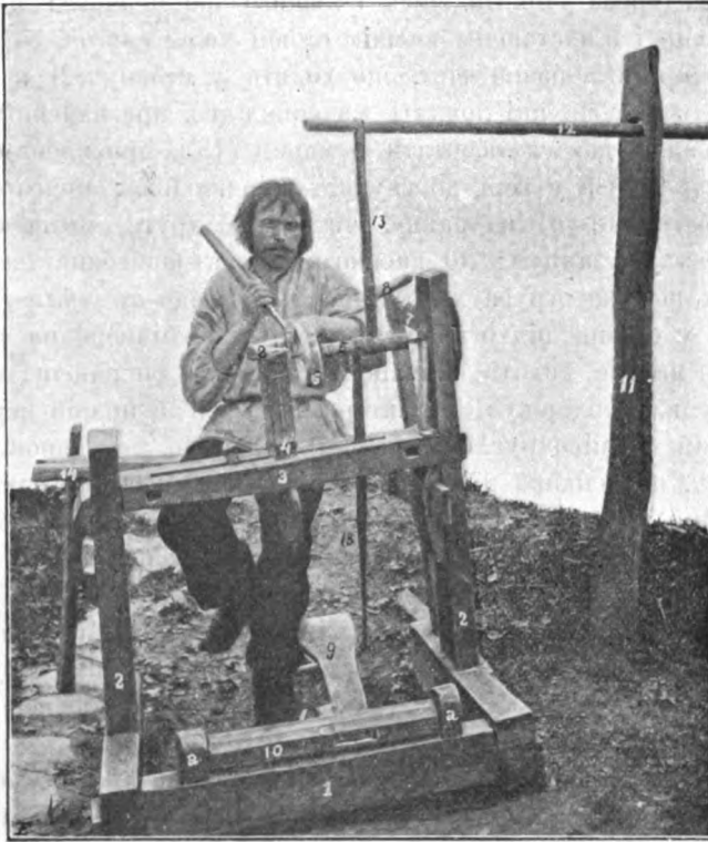
223 Василь Шкрибляк при токарні. 1. Підстава; 2. 2. стовпи; 3. огниво; 4. занць; 5. валок; 6. матеріял на ракву; 7. решітце; 8. кривуля; 9. постія; 10. воротило, яке ходить у жабках а. а.; 11. стовп; 12. жердня; 13. ремінь; 14. сідєць.
