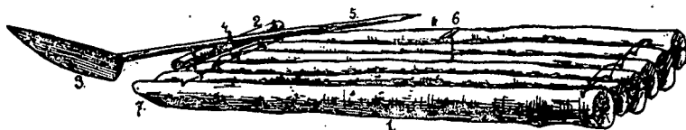
126. Тальба. 1. Ковбка підчулені від чола 7; вони повязані в поперек розкрутею; 2. столець, в янім ходять на сворені 4. перка аложена з дошки 3. і дугара 5; 6. свердел або сохар.
