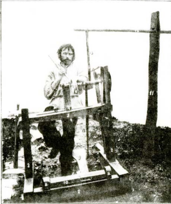
223 Василь Шкрибляк при токарні. 1. Підстава; 2. 2. стовпи; 3. огниво; 4. валяць; 5. валок; 6. матеріал на раму; 7. решітка; 8. явчули; 9. постіль; 10. воротило, яке ходить у жабках а. а.; 11. стови; 12. жерда; 13. ремінь; 14. сідець.
