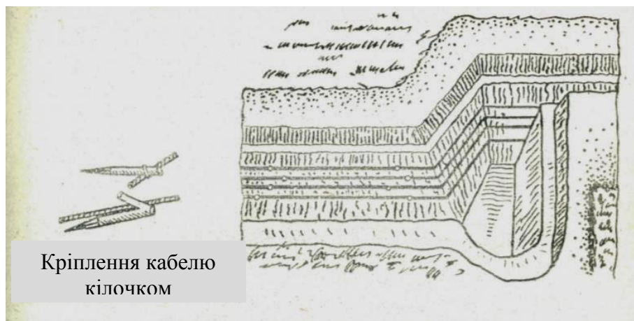
Рис. 37. Кріплення кабелю в траншеї
