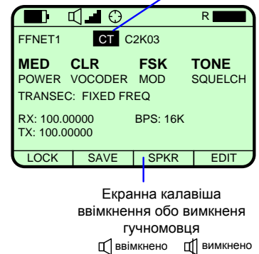
Рис. Д.11.15. Зміна параметра на дисплеї
