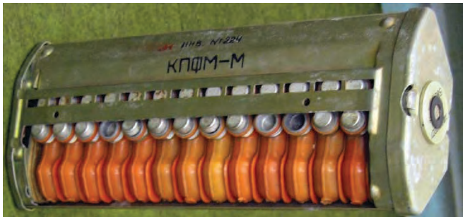
Малюнок 5.6.8 – Головна частина ракети 9М27К3 (зверху) та касета КПФМ-М на 26 мін (знизу)
