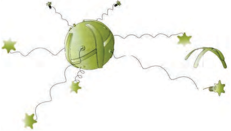
Малюнок 6.6.5 – Міна POM-1 після відкидання якорів-грузиків
