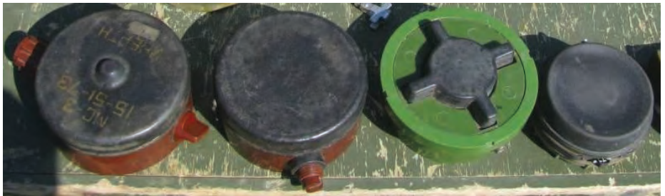
Малюнок 8.1.2 – Міна МС-3 в порівнянні з різними протипіхотними мінами. Зліва направо: МС-3; ПМН; ПМН-2; ПМН-4
