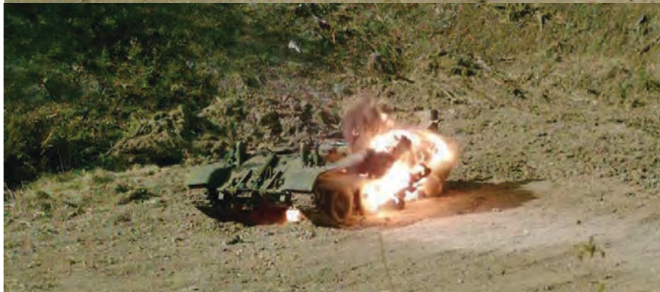
Малюнок 3.2.5 – Відеорозкадрування влучання УЯ міни ТМ-83 в борт БРЕМ. По білому кольору вогню зрозуміло, що температура 5-7 тисяч градусів
