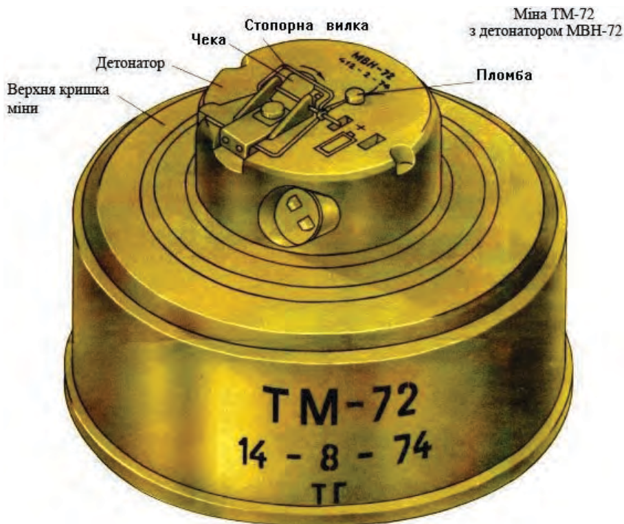
Малюнок 2.1.1 – Міна ТМ-72 з детонатором МВН-72
