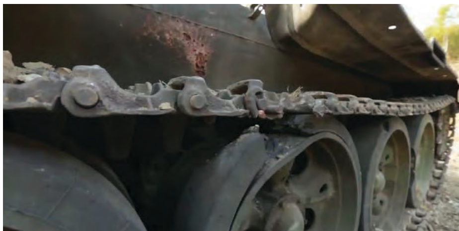
Малюнок 3.2.7 – Дія ТМ-83: пошкоджено каток, гусеницю, борт не пробито, тому що УЯ попало в трак і роздвоїлось, знизивши силу пробиття
