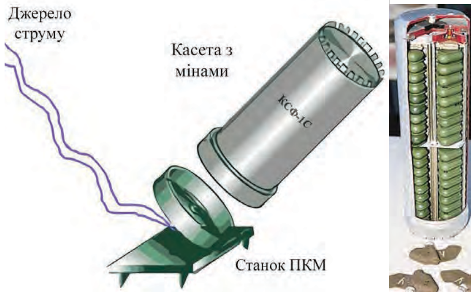
Малюнок 5.6.2 – Касета КСФ-1С: схема та розріз
