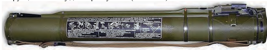
Малюнок 3.1.4 – інструкція-пам'ятка для користування ТМ-73 на корпусі РПГ-18
