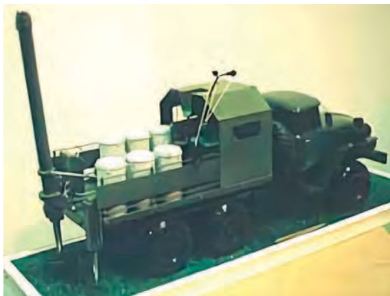
Малюнок 7.9.4 – Установник мін М-225 на базі ЗІЛ-131 (макет)
