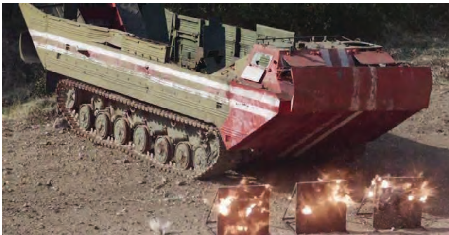
Малюнок 7.4.6 – Зверху: Підрив МОН-90 за 15 м від гусеничного транспортера ПТС-2; Всередині: Перед ПТС встановлено 6-мм та 4,5-мм броньові плити; Знизу: Влучання ГЗЕ від міни МОН-90 в вищевказані бронеплити та корпус ПТС-2. Пробито всі бронеплити, як 4,5 мм, так і 6-мм; Лоб корпусу ПТС-2 завтовшки 5 мм з неброньової сталі також пробито в багатьох місцях, причому як відкриті ділянки, так і за броньовими плитами
