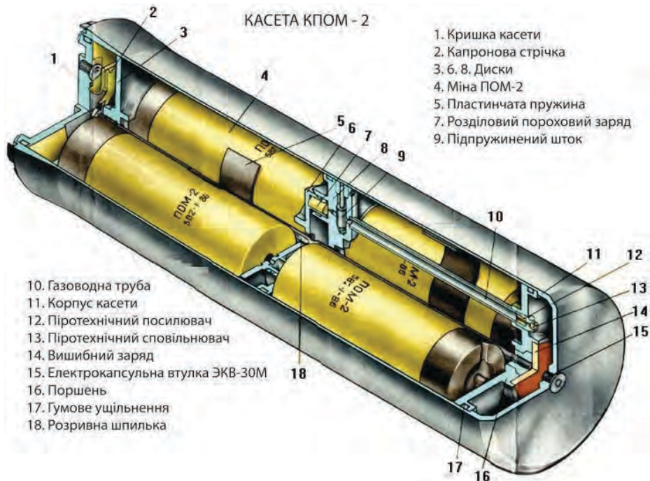
Малюнок 6.7.3 – Касета КПОМ-2, внутрішня будова
