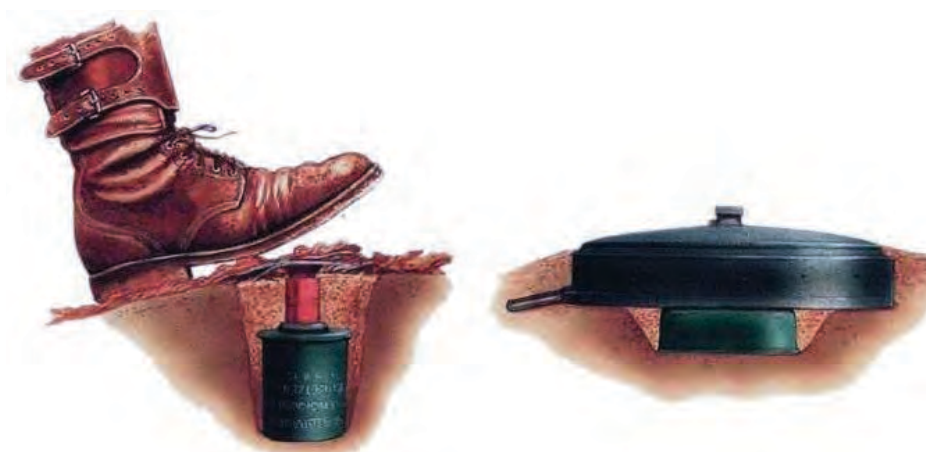
Малюнок 8.10.5 – Замаскована протипіхотна міна, та міна пастка під протитанковою міною
