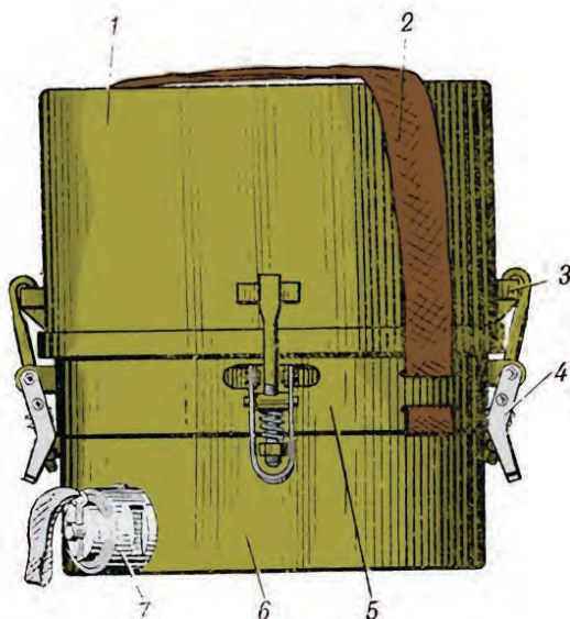
Малюнок 8.7.1 – Міна МЛ-2: 1 - протиміношукачевий датчик; 2 - ручка; 3 - виступ; 4 - замок; 5 - кільце; 6 - блок управління; 7 - пусковий механізм
