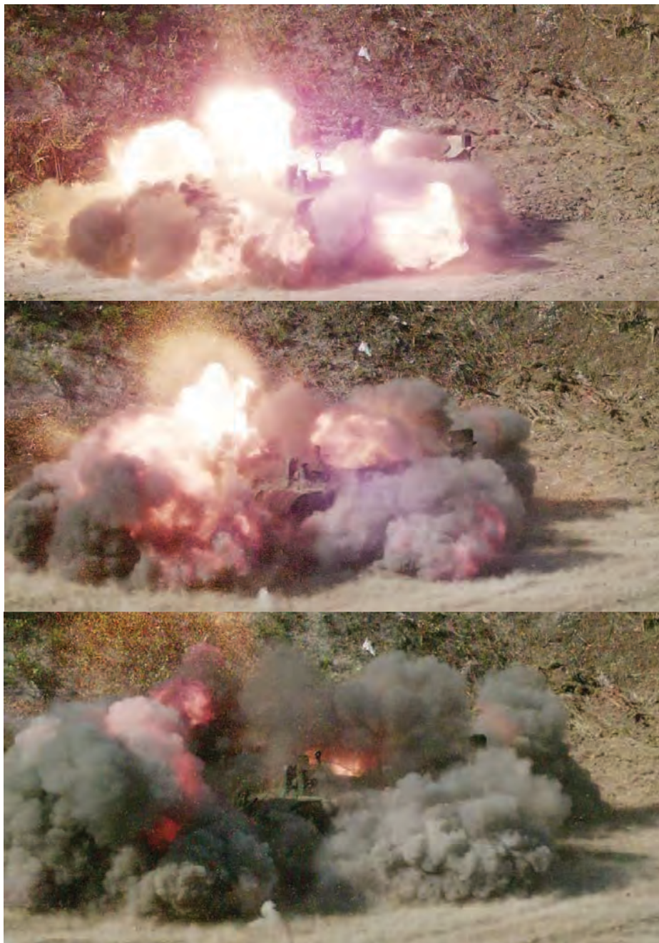
Малюнок 2.1.5 – Відеорозкадрування підриву на міні ТМ-72, з детонатором МВН-72, БРЕМ на базі танка Т-55 (продовження), днище пробито, всередині виникла пожежа
