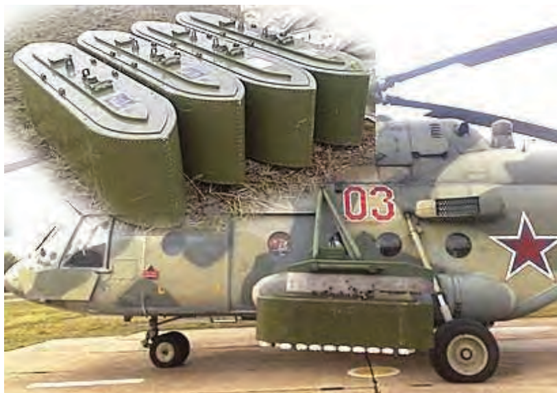
Малюнок 6.6.3 – Міни ПОМ-1 в контейнері ВСМ-1 на гелікоптері Мі-8. Зверху зліва – чотири контейнери ВСМ-1 для касет з мінами ПОМ-1
