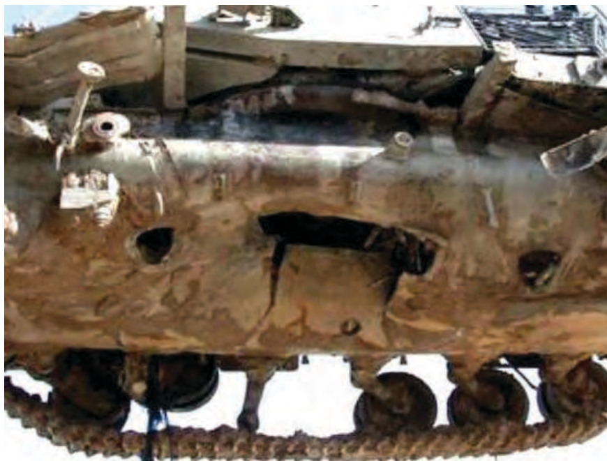
Малюнок 2.1.3 – Израїльський танк «Magach-7» з пробоїною від міни TM-72, Південний Ліван
