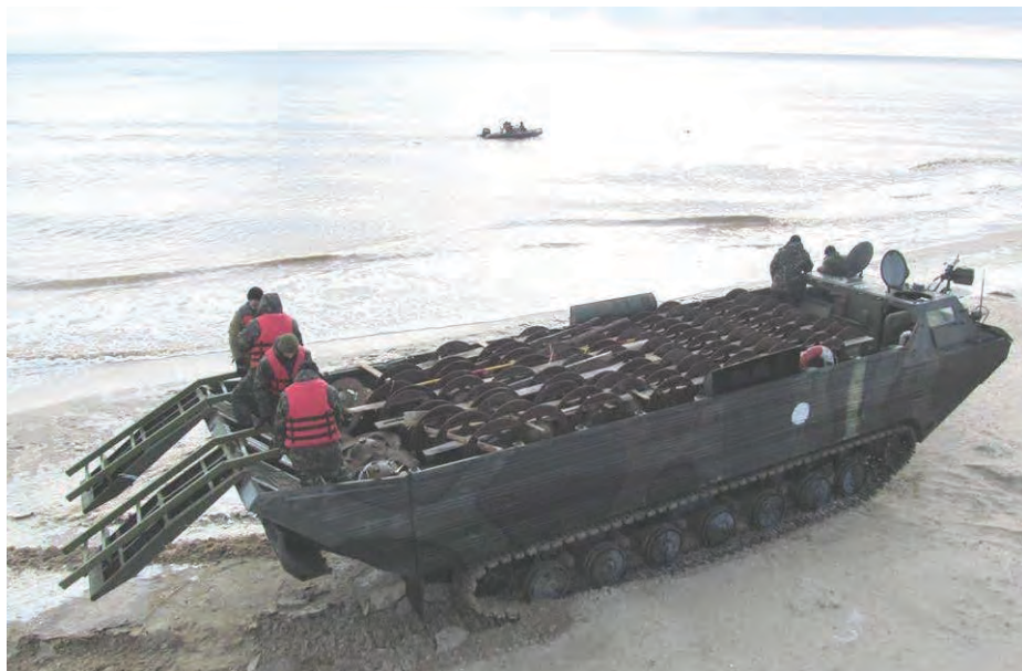
Малюнок 1.4.4 – Транспортер ПТС ЗСУ підготовлений для мінування акваторії Азовського моря мінами ПДМ-3Я та ПДМ-1М, Маріуполь 2016 р
