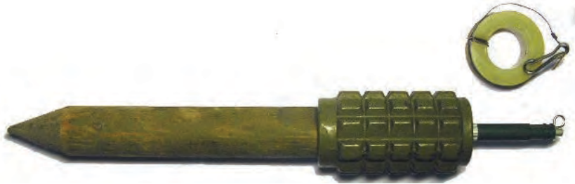
Малюнок 6.2.1 – Міна POM3-2M, з детонатором МУВ та дротом для натягіння на катушці
