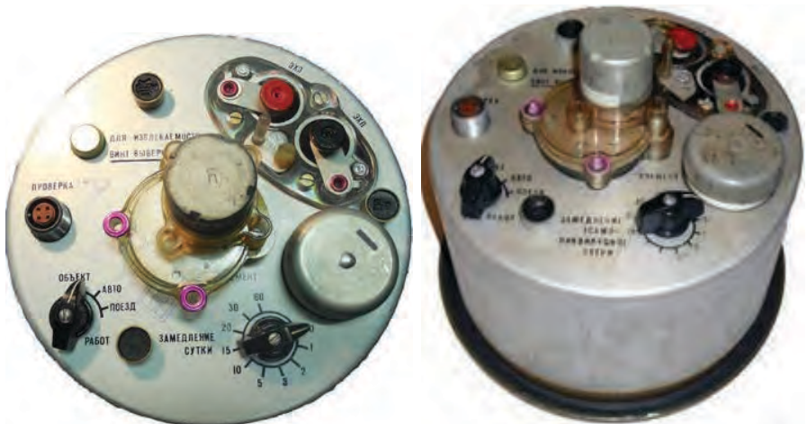
Малюнок 10.1.2 – Детонатор ВМЗУ міни МЗУ – зліва, та ВМЗУ-С міни МЗУ-С
