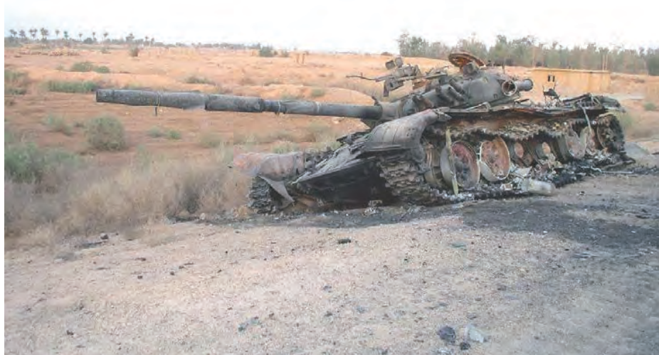
Малюнок 2.2.4 – 14.12.2014 р. Маріуполь, Україна. Т-72А, так званої ДНР, підірвався на міні ТМ-89, яка була встановлена саперами ДНР. Полопались торсіони, відлетіли середні катки і танк упав на брюхо
