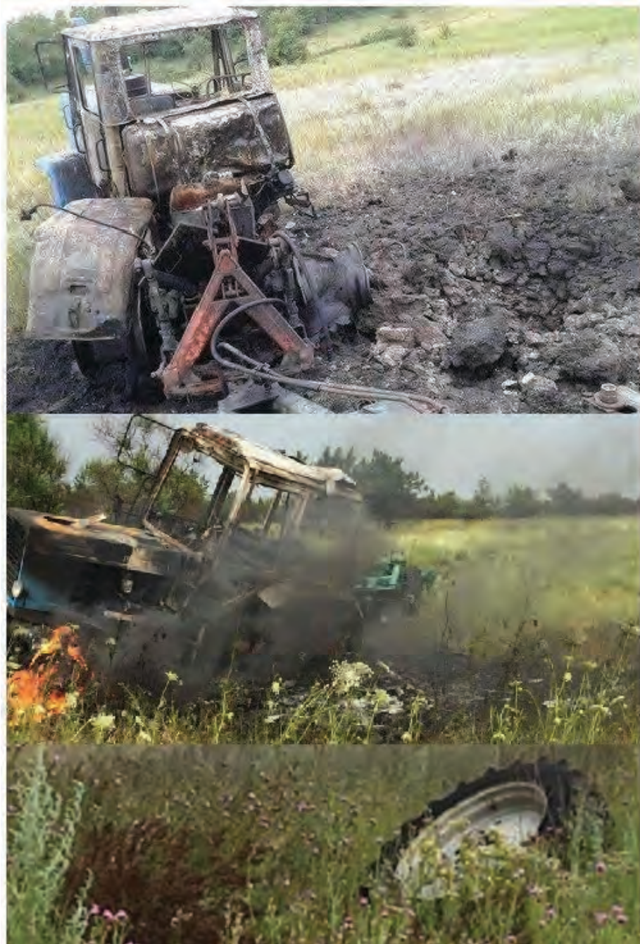
Малюнок 1.1.5. – Підрив трактора на міні ТМ-46 в зоні АТО. Відірвано колесо, у водія контузія
