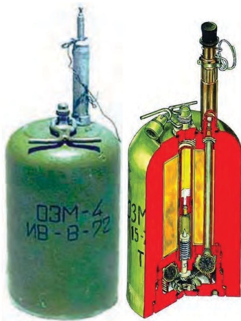
Малюнок 6.4.1 – Міна ОЗМ-4, загальний вигляд з детонатором МVB-4 – зліва, та в розрізі з детонатором МVB-3 – справа
