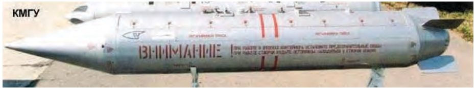
Малюнок 6.6.4 – Міни POM-1 в контейнері КМГУ для підвішування на штурмові літаки
