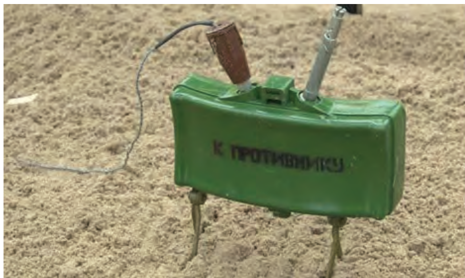
Малюнок 7.3.8 – Міна МОН-50, встановлена на ґрунті, з детонатором МВЭ-72, який має датчик цілі в вигляді малопомітного тонкого обривного дроту
