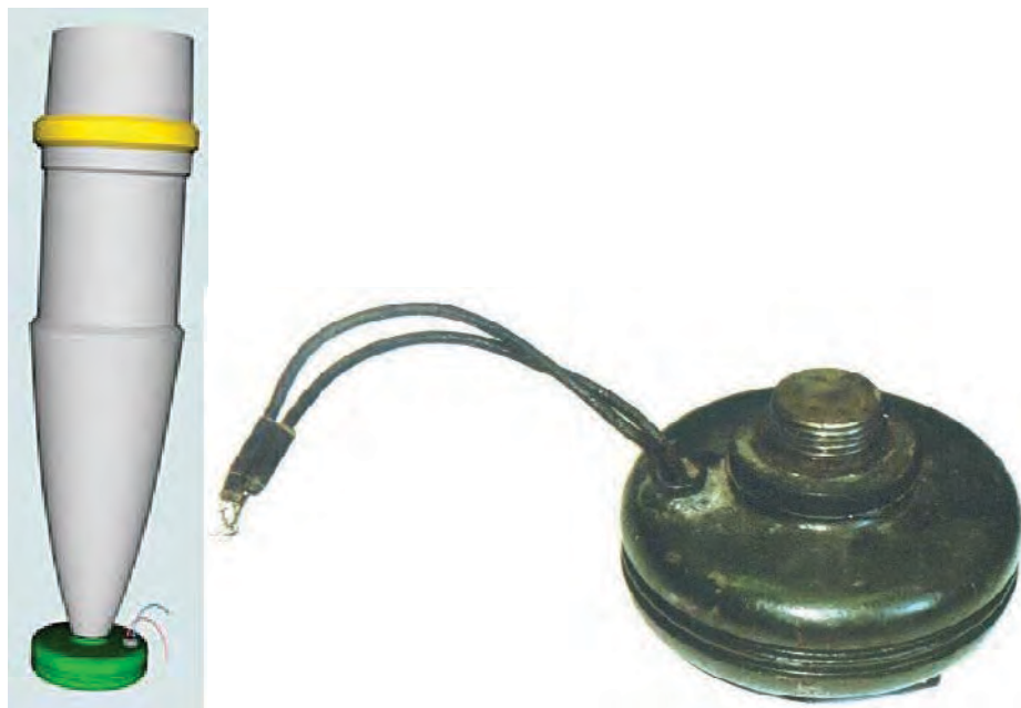
Малюнок 7.2.1 – Міна «ОЗМ с УВК» в зборі – зліва, та універсальна вишибна камера – справа
