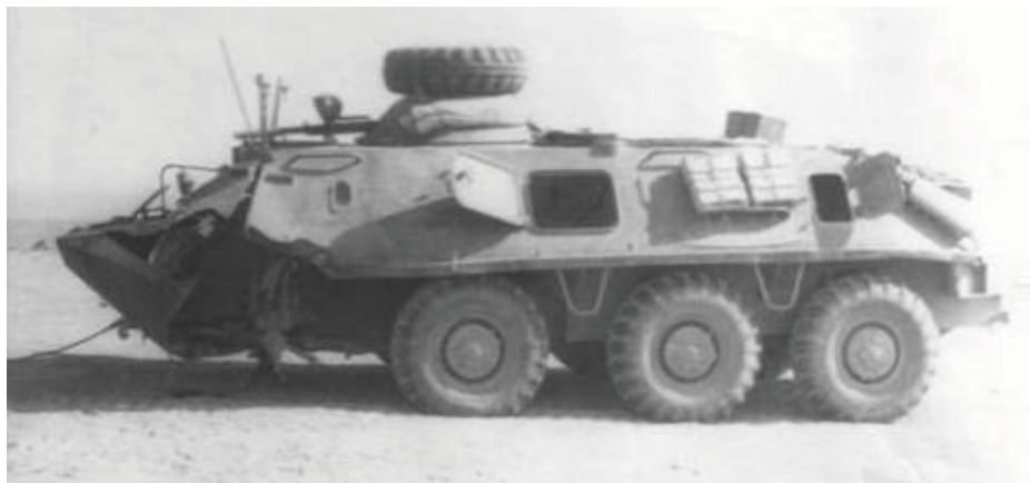
Малюнок 1.3.5 – БТР-60ПБ після підриву на міні ТМ-57, ДРА. М/в загинув на місці, екіпаж отримав поранення, десант, що був на броні, отримав контузії
