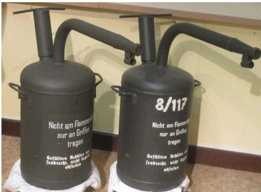
Фото Е.31. Німецький одноразовий фугасний вогнемет Abwehr Flammenwerfer 42 (A.Fm.W.42)
