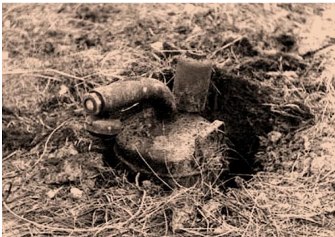
Фото Е.27, Е.28. Фугасний вогнемет ФОГ-2, СРСР: загальний вигляд, встановлений для стрільби
