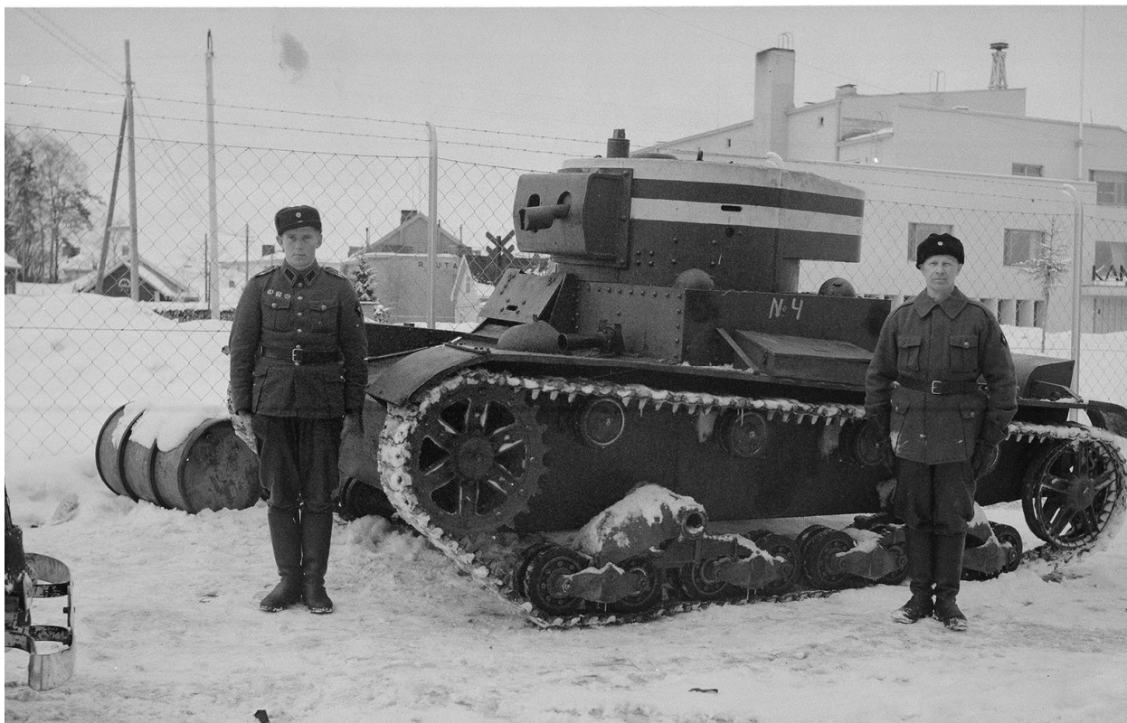
Фото Д.15. Трофейний радянський вогнеметний танк ХТ-130, прийнятий на озброєння фінської армії. Фінляндія, квітень 1940 р.
