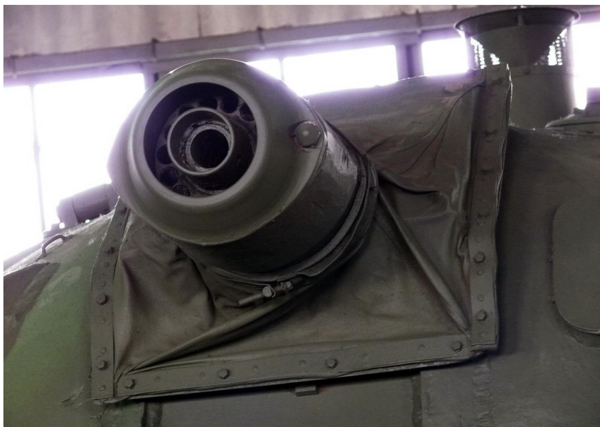
Фото Е.80. Вогнемет ОМ-250, встановлений у башті танка “Об’єкт 483”
