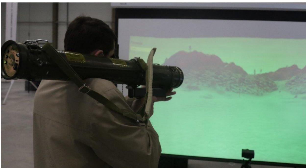
Фото 3.11, 3.12. Імітатор вогнемета РПВ-16 від тренажерного комплексу компанії ТОВ «Науково-виробниче підприємство «Метекол» (м. Ніжин)
