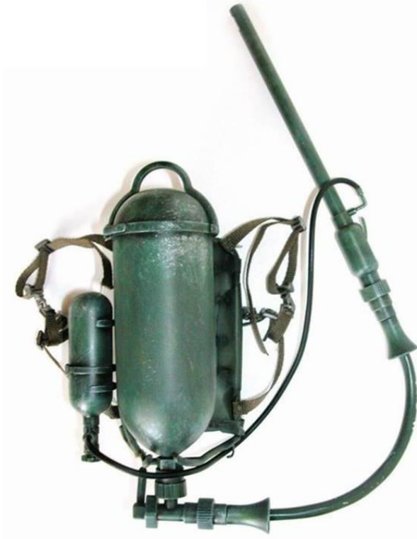
Фото Д.1, Д.2. Ранцевий піхотний вогнемет Flammenwerfer 35 (Fm.W.35), Німеччина, 1935 р.
