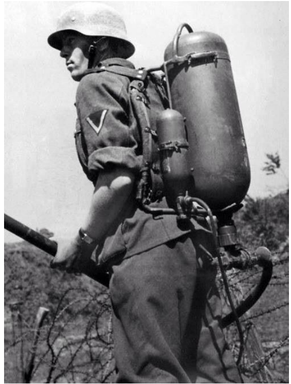
Фото Д.1, Д.2. Ранцевий піхотний вогнемет Flammenwerfer 35 (Fm.W.35), Німеччина, 1935 р.
