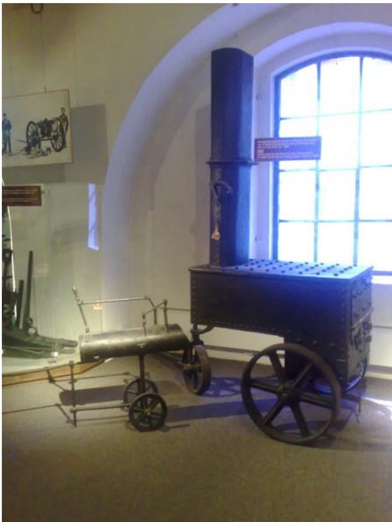
Фото В.10. Рухома гартувальна піч (реконструкція)
