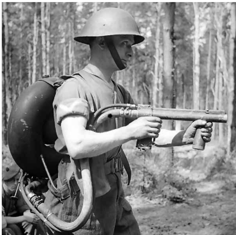
Фото Е.8. Британський піхотинець з ранцевим вогнеметом Flamethrower, Portable, No 2. Mk II
