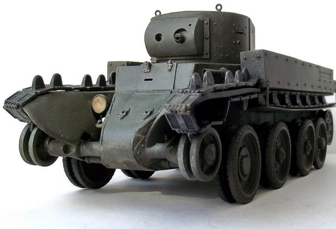
Рис. Д.7. Дослідний колісно-гусеничний танк ХБТ-7. СРСР, 1937 р. (модель)
