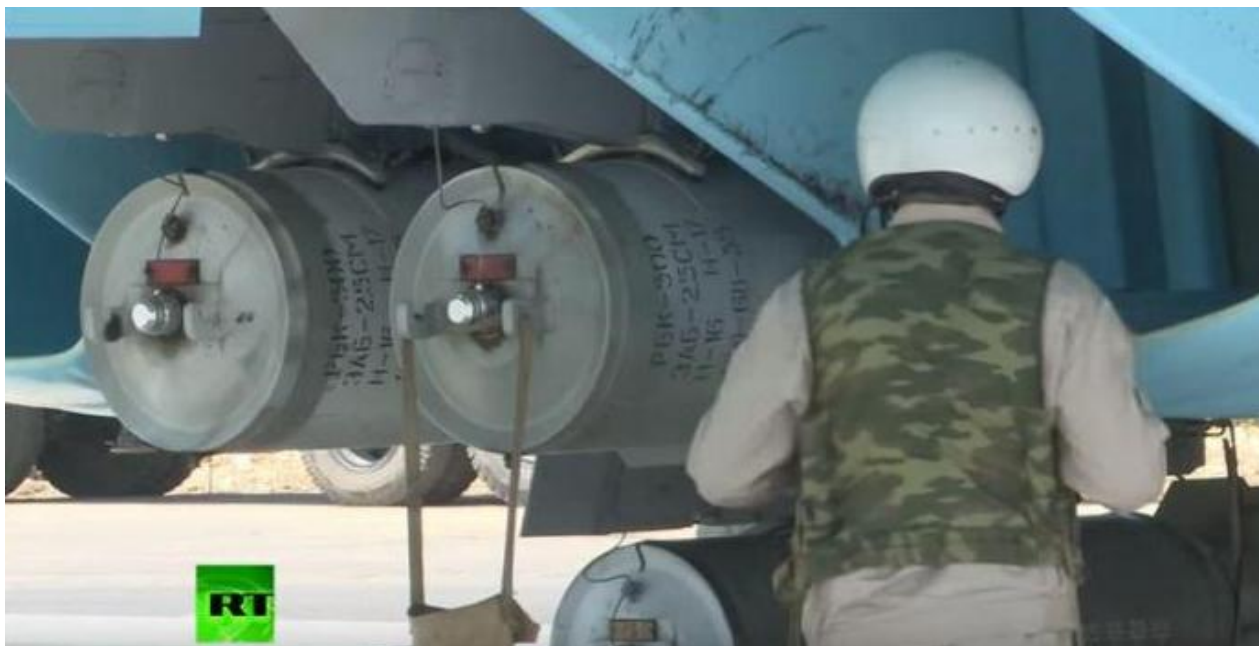
Фото Ж.24. Запалювальна авіаційна бомба РБК-500 ЗАБ-2,5СМ під крилом винищувача-бомбардувальника СУ-34. Російська авіабаза “Хмеймім”, Сирія
