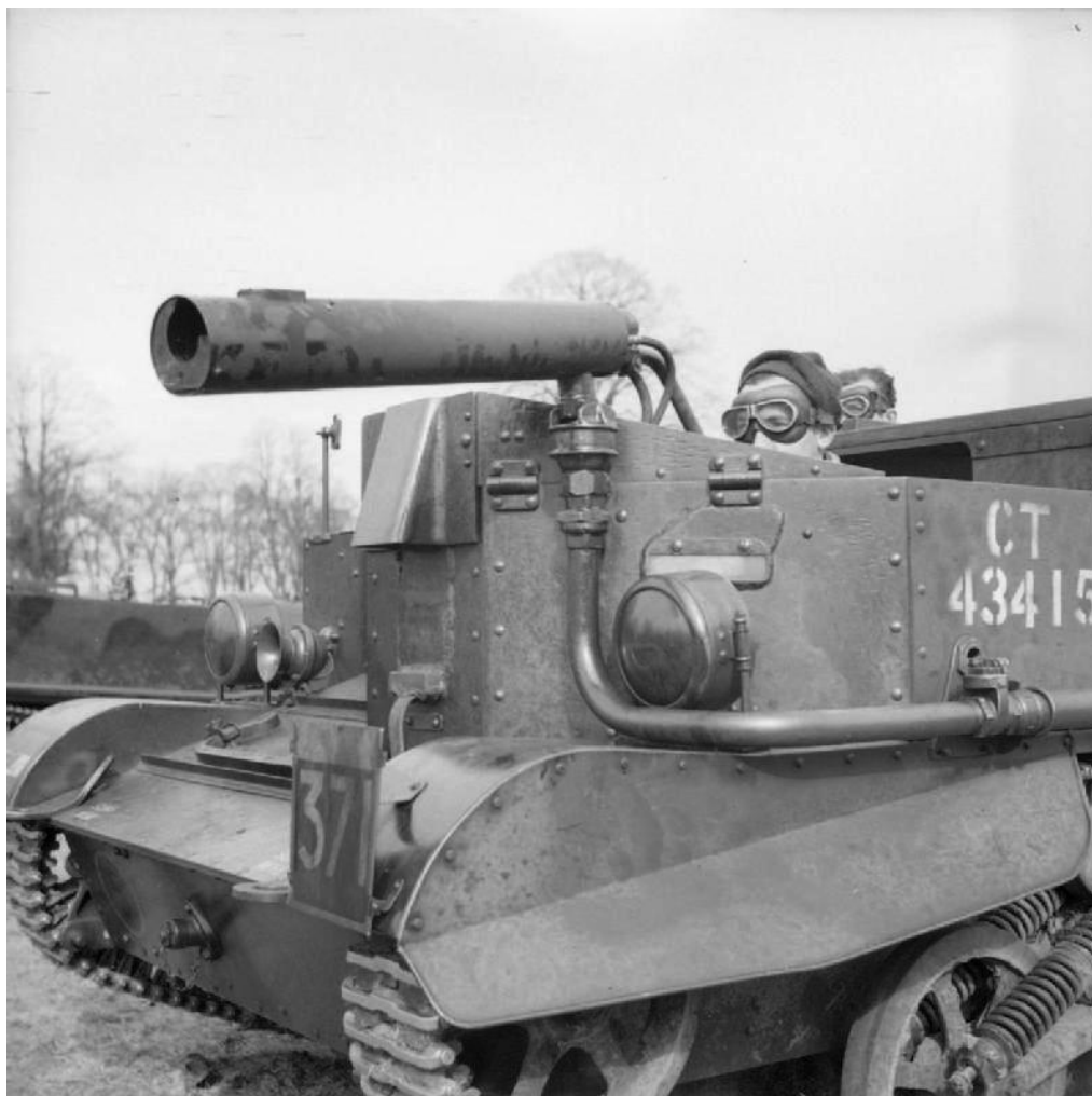
Фото Е.64. Лобова частина самохідного вогнемета Ronson flamethrower з брандспойтом з вогнемета, Шотландія, березень 1942 р.
