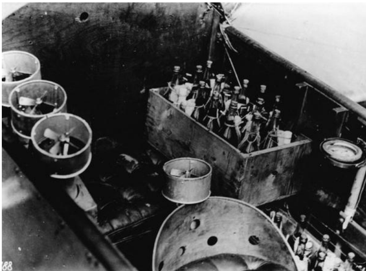
Фото Г.20. Бойове навантаження літака “Воазен” (Voisin): фугасні авіаційні бомби і пляшки із запалювальною сумішшю
