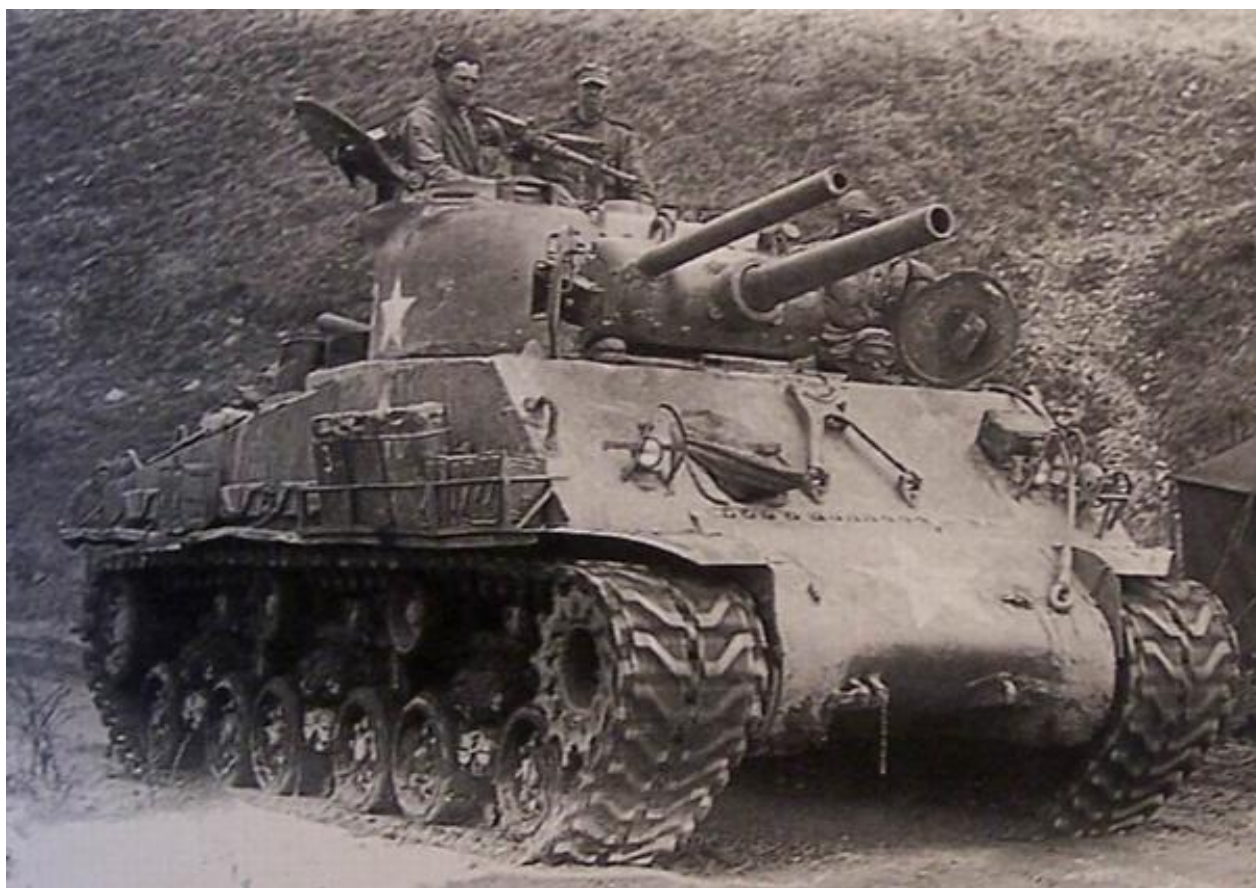
Фото Е.68. Танк М-4 “General Sherman” (варіант спареного вогнемета з гарматою)
