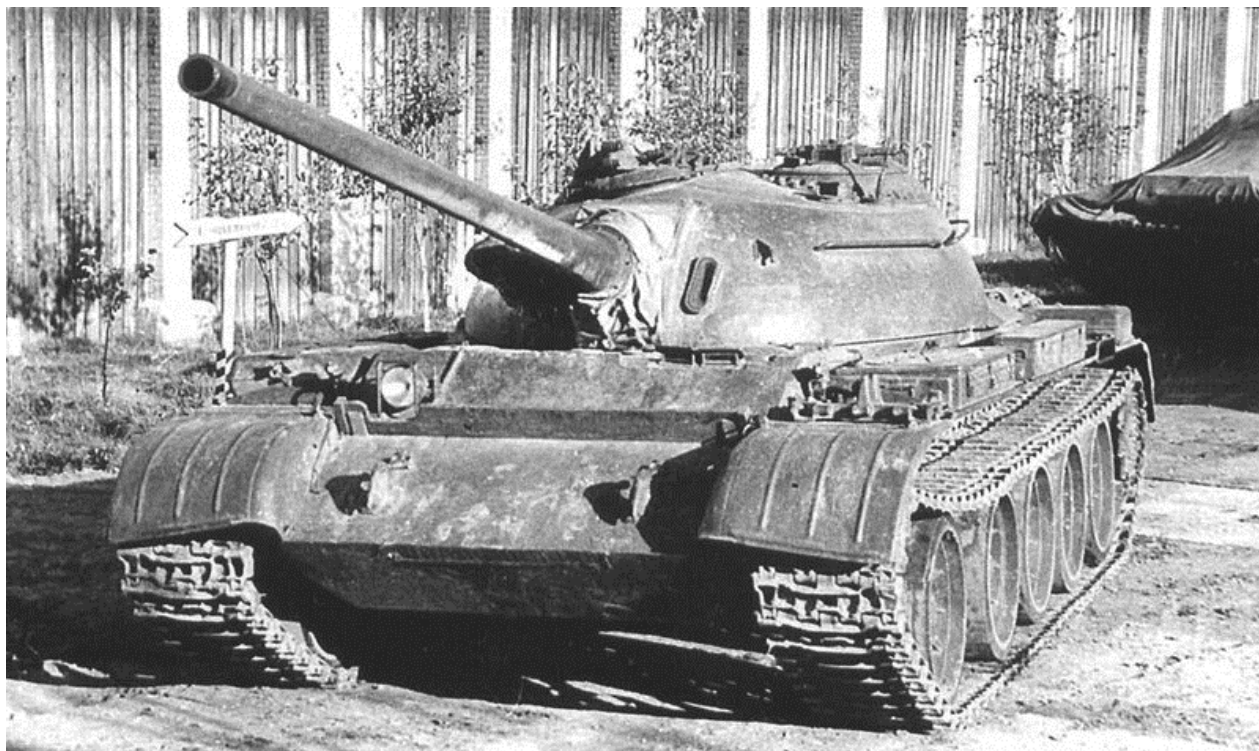
Фото Е.75. Вогнеметний танк ТО-54, СРСР
