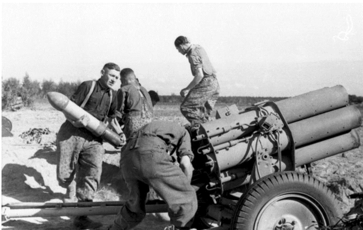
Фото Е.82. Розрахунок заряджає 150-мм шестиствольний реактивний міномет №.W 41 зр. 1941 р., Німеччина
