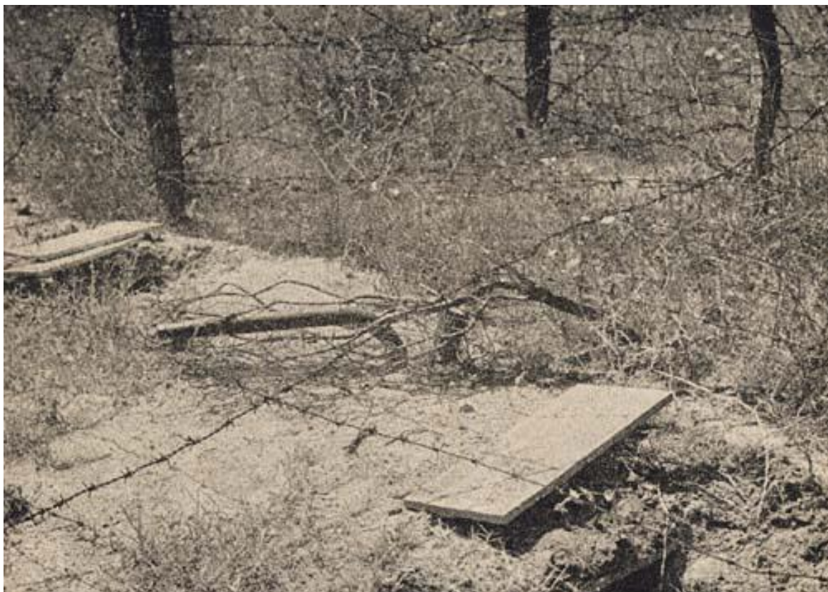
Фото Е.33. Фугасний вогнемет А.Фм.В.42, встановлений під колючим дротом. Над землею знаходяться лише сопло і циліндр з паливом
