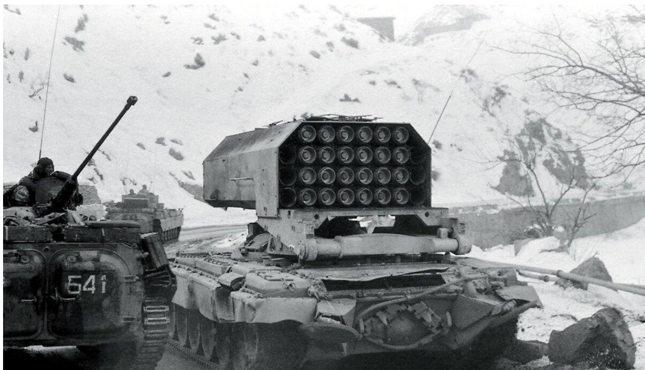
Фото Ж.13. ТОС-1 “Буратино” в Афганістані. У країні напрямні не встановлені реактивні снаряди зادля підвищення захищеності машини від влучення в короб
