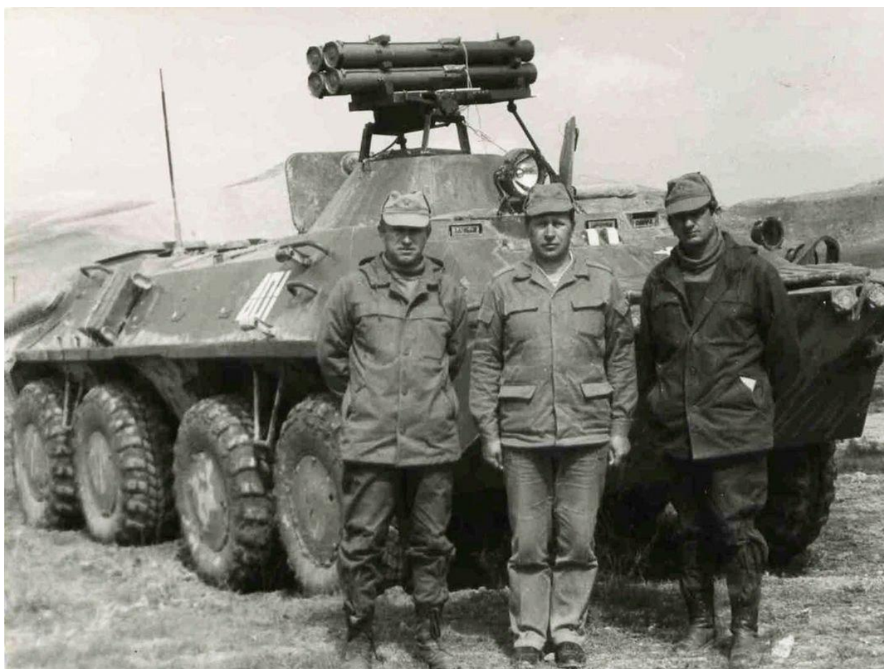
Фото Ж.6, Ж.7. Спеціальна саморобна бойова машина на базі БТР-70 з пакетом із 4-х вогнеметів РПО “Рысь” на башті. Афганістан, 1980-ті роки
