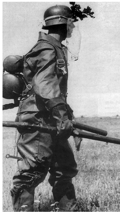
Фото Е.2. Німецький вогнеметник із ранцевим вогнеметом Flammenwerfer 41 (FmW.41)
