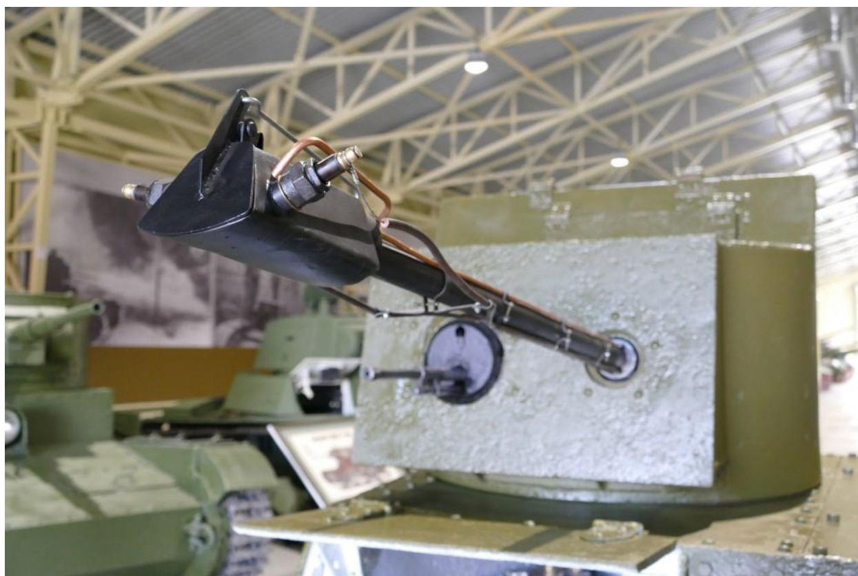
Фото Д.10. Вогнемет КС-24, встановлений на танку ХТ-26 (реконструкція)
