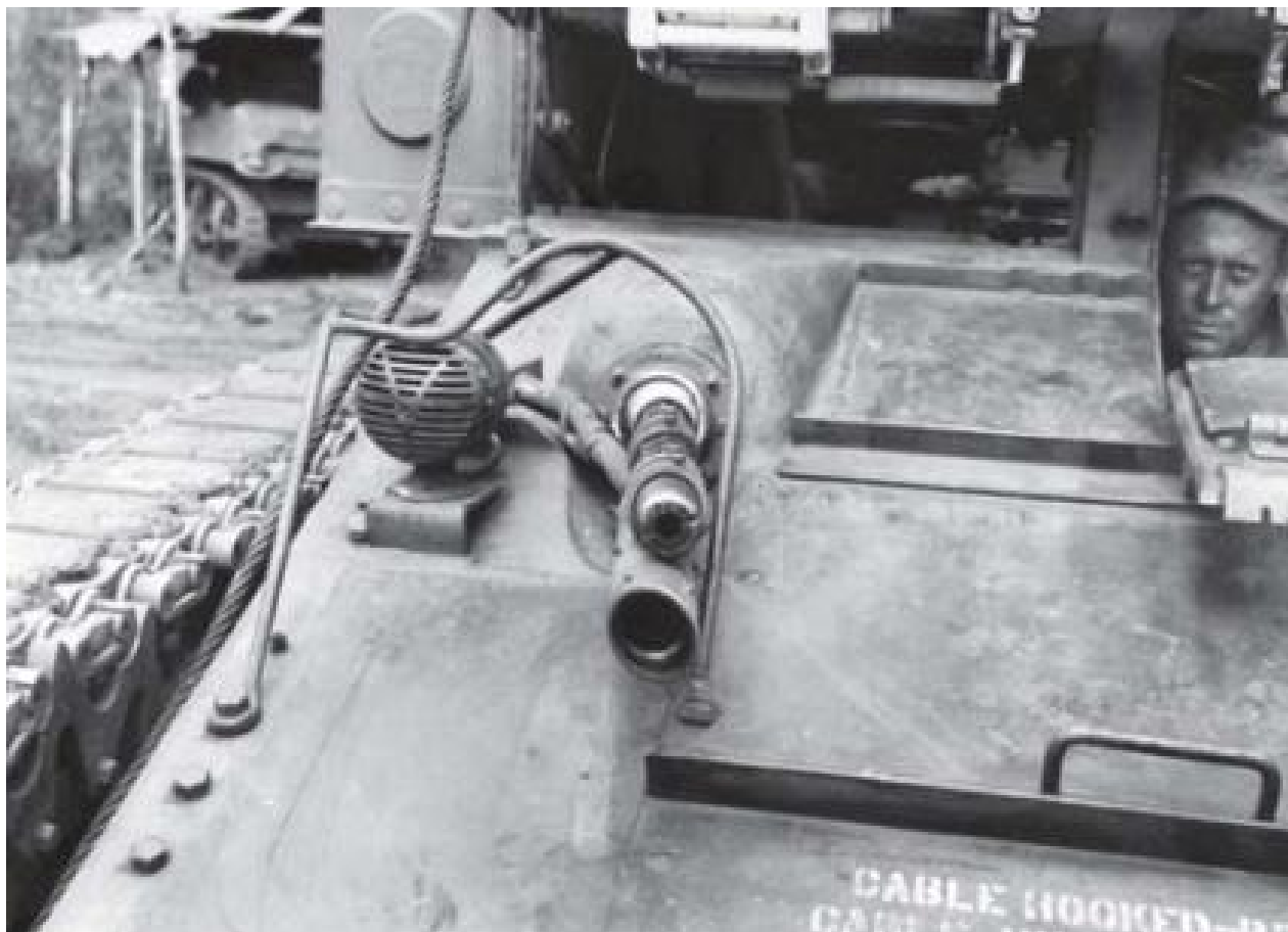
Фото Е.58. Вогнемет “Ronson F.U.L Mk.IV” на танку М3А1 Satan
