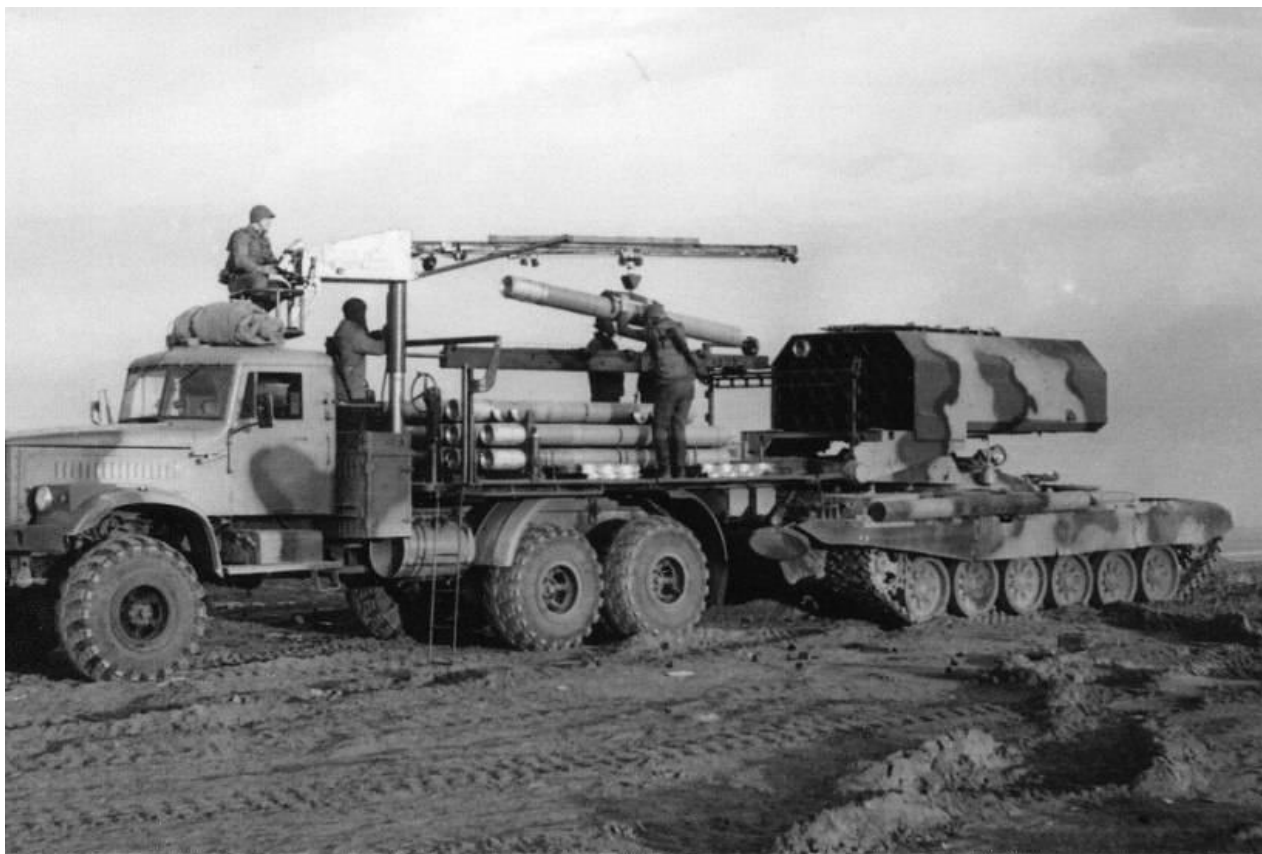
Фото Ж.14. Транспортно-заряджальна машина на шасі КраЗ-255Б
