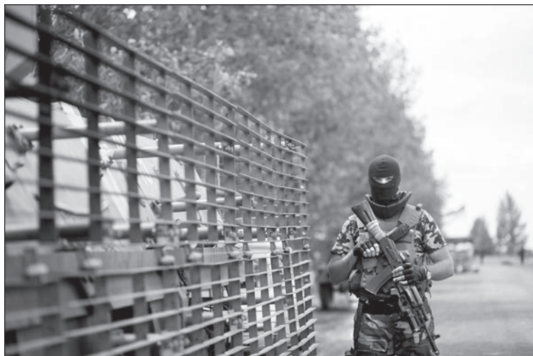
24 червня 2014 року. Блокпост № 7 у с. Билбасівка на західній околиці Слов'янська. Десантник ЗСУ біля БТР-4Е НГУ, на якому приварено протикумулятивні решітки, що захищали від влучення гранатометів ворога. Цією бронетехнікою посилювали блокпости навколо міста. Фото Олексія Лебеда
