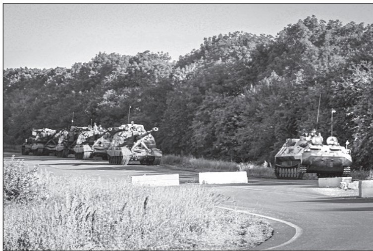
Вогневий взвод батареї самохідних дивізійних артилерійських гаубиць (САУ) 2С19 Мста-С калібру 152 мм із машиною керування вогнем попереду на підступах до Слов'янська. Фото Олексія Лебеда
