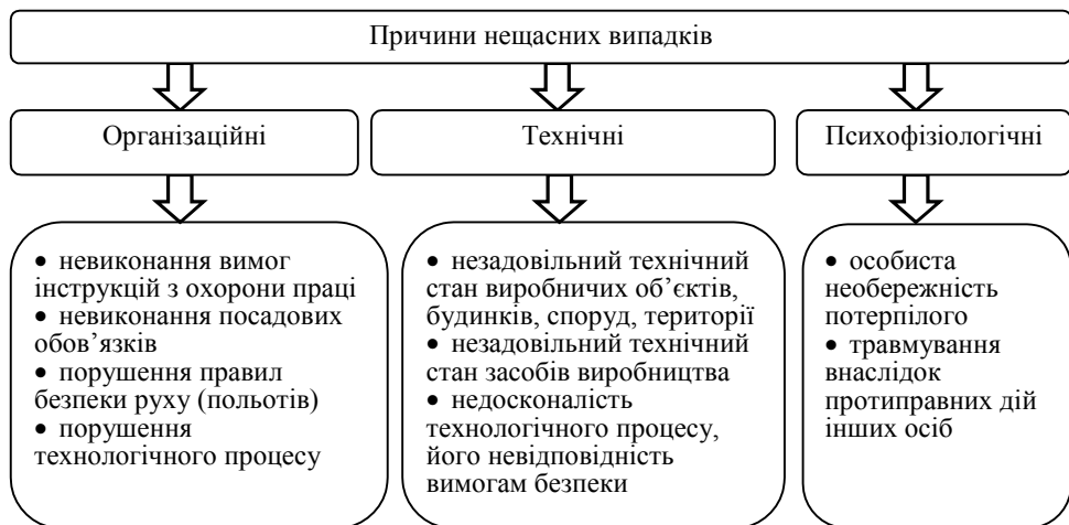
Рис. 7.2. Найбільш поширені організаційні, технічні та психофізіологічні причини нещасних випадків в Україні у 2013 р.
