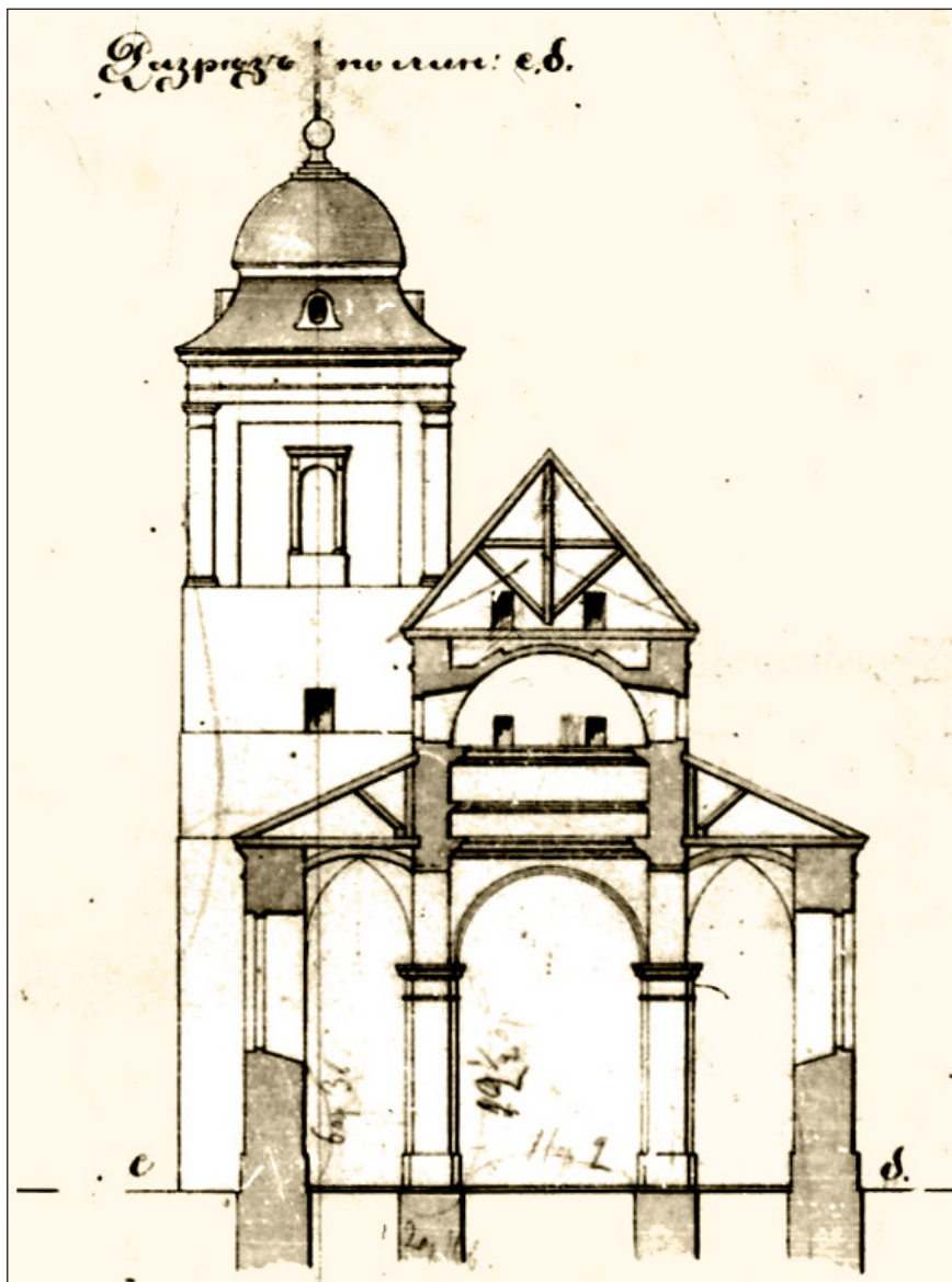
Рис. 6. Поперечний розріз костелу з вежею на задньому плані. РДІА.
