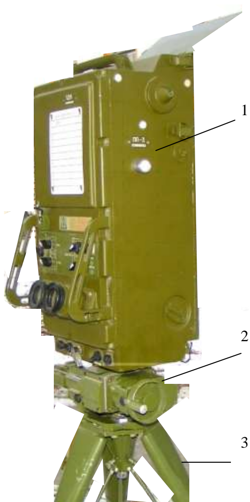
Рисунок 2.36 – Лазерний далекомір-цілевказівник 1Д15: 1 – прийомопередавач; 2 – система наведення; 3 – тринога
