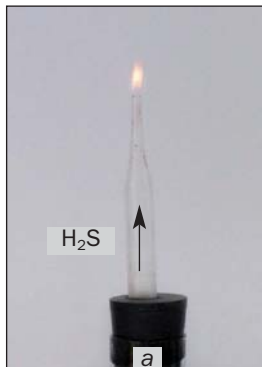
Мал. 46. Горіння сірководню: а — за достатнього доступу повітря; б — за нестачі повітря
