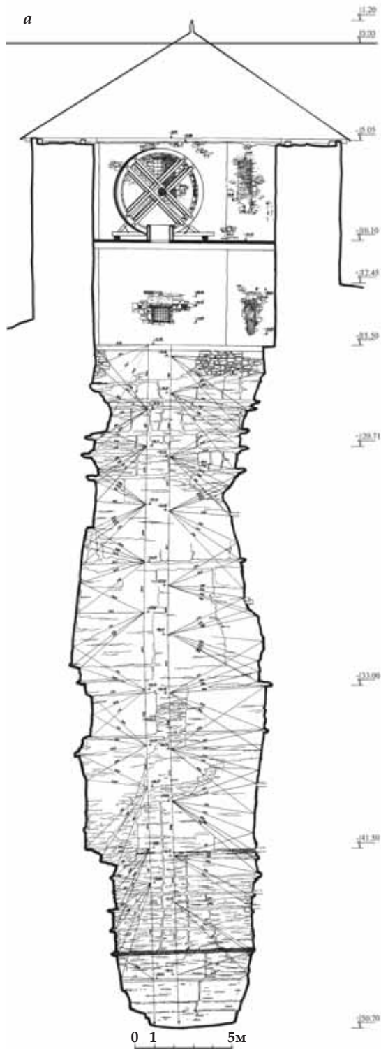
Лл. 259. Старий замок. Башта Нова Східна з криницею. Перерізи: а – 1972 р. (обмір Є.Пламеницької, С.Буркацького, А.Тюпича, Л.Лернера, П.Крисоченка, В.Вацєнка; кресленик Є.Пламеницької), б – 1811 р. (матеріали РДВІА)
