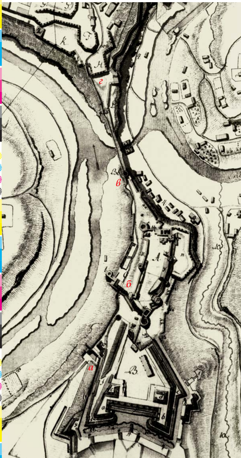
Лл. 373. Фортифікаційна система західного в'їзду до міста за планом 1773 р. РДВІА; (а – Підзамкова брама, б – Пільна брама, в – надбрамна бастион св. Анни, г – Міська брама)
