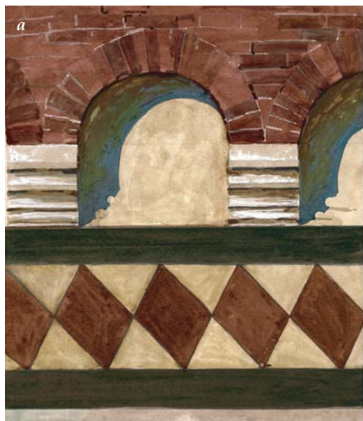
Іл. 185. Башта Рожанка: а - реконструкція колористичного рішення аркатурного парапету з поліхромним фризом. Автор Є.Пламеницька; б - бійниця III ярусу башти з граф'єю; фото О.Пламеницької
