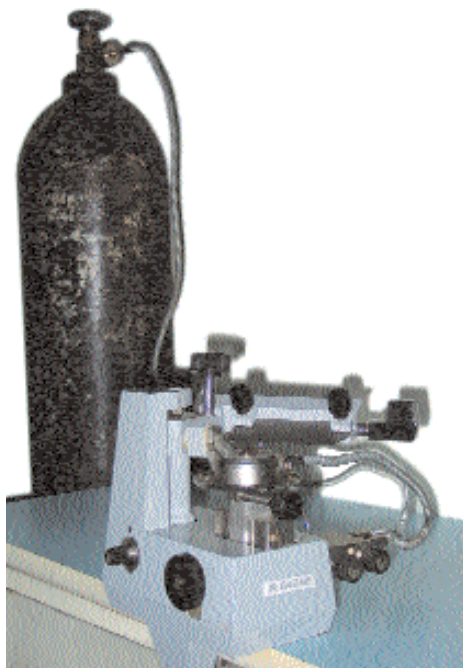
Рис. 2. Заморожуючий мікроскоп із вуглекислим газом МЗ-2.158.
