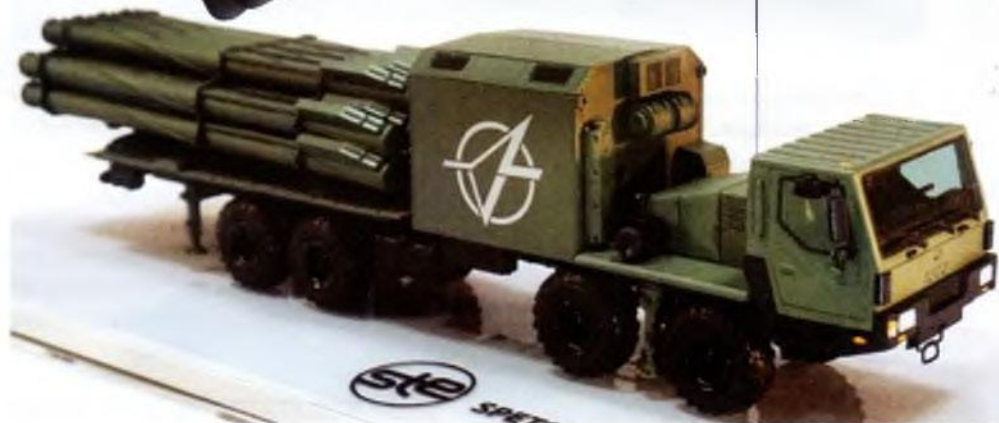
Wyrzutnia Wilcha osadzona na podwoziu KrAZ-7634NE-000.
