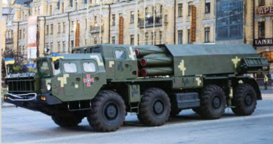
▲ Wyrzutnia Wilcha typowo osadzona na sowieckim podwoziu MAZ-543 w trakcie defilady w 2018 roku.
