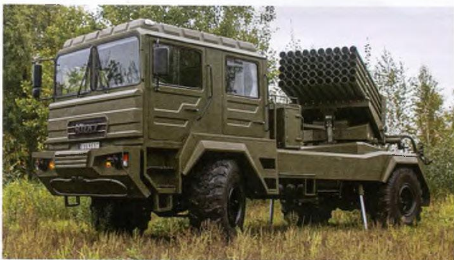
▲ 50 prowadnic pod pociski raketowe kal. 122 mm, czyli wyróżniająca się nie tylko zmienionym podwoziem (w tym przypadku KrAZ-5401NE) wyrzutnia BM-21UM Berest .
