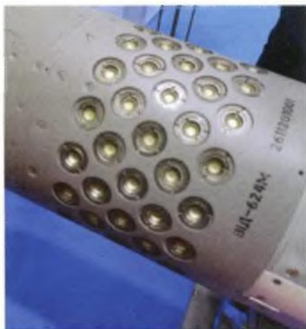
▲ Widok na wieniec dysz silniczków korygujących kierunek lotu rakiety R-624M.
