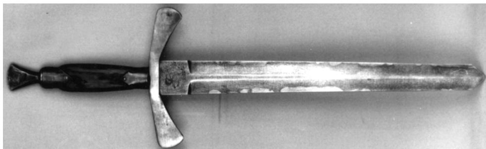
Рис. 12. Меч із булатної сталі з кількістю вуглецю 1,05%, виготовлений на заводі «Більшовик» (м. Київ) із витисненими карбідами заліза на лезо (білі плями)
