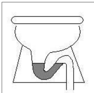
Рис. 4.16. Водяний затвор санітарного пристрою (принцип сифона)
