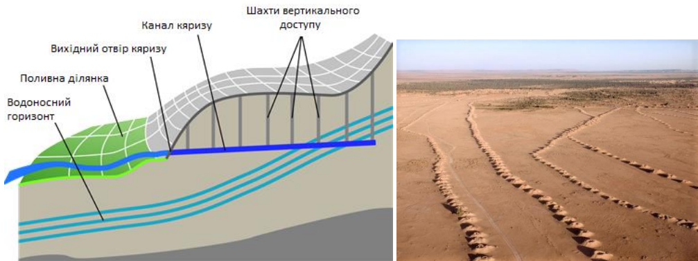
Рис. 4.11. Конструкція кяризу та його зовнішній вигляд
