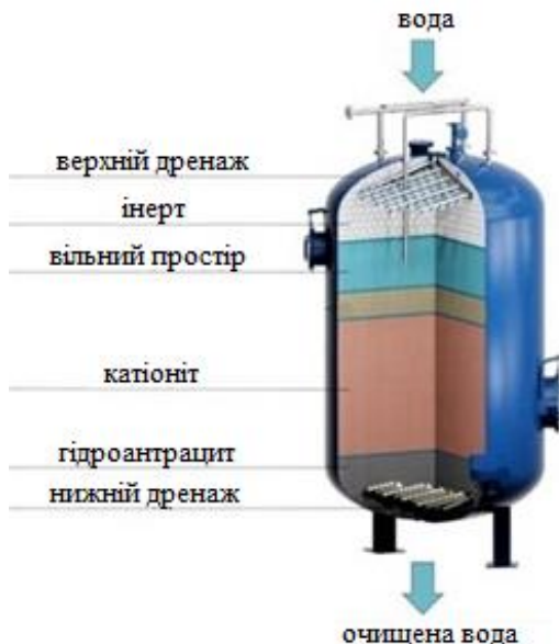
Рис. 7.1. Схема роботи Na-катіонітового фільтра
