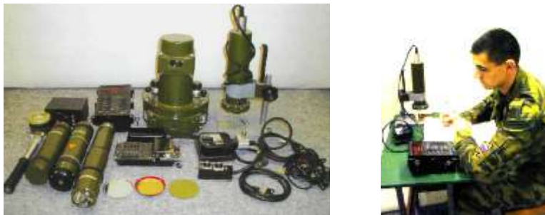
Рис. 4.48. Вимірювач іонізуючих випромінювань універсальний ИМД-13
