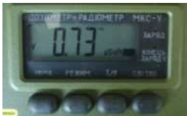
Рис. 3.57. Вимірювання ПЕД фотонного іонізуючого випромінювання ( \mu\text{Sv/h} ) за допомогою комбінованого блока детектування (КБД)
