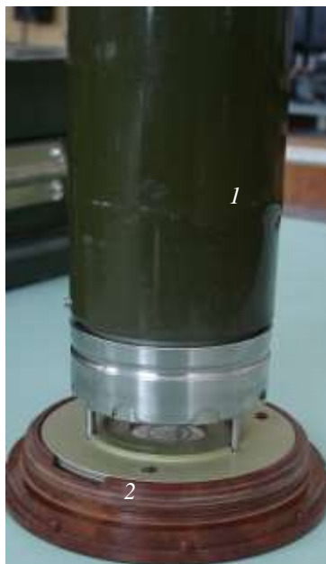
Рис. 4.21. Вимірювання без фільтра ( \beta+\gamma ): 1 – торець БД;
