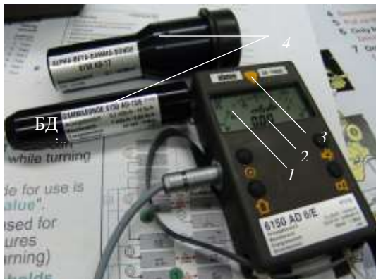
Рис. 4.39. Вимірювач потужності дози 6150AD6/E
