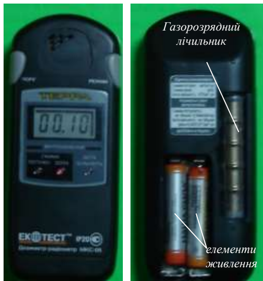
Рис. 3.62. Передня та задня панель приладу
