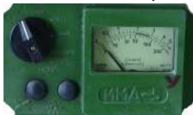
Рис. 3.39. Вимірювач потужності дози ИМД-5
