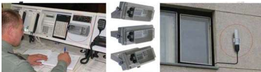
Рис. 4.44. Вимірювач потужності дози ИМД-2С
