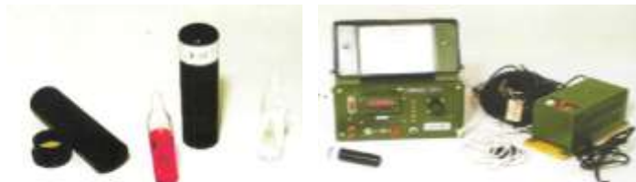
Рис. 4.49. Індивідуальний хімічний гамма-нейтронний дозиметр Д-13
