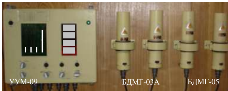
Рис. 3.86. Дозиметрична установка КДУ-6Б
