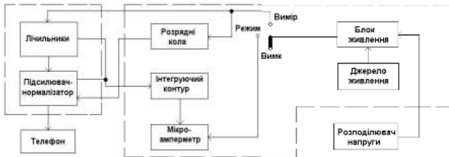
Рис. 3.32. Структурна схема приладу ДП-5В
