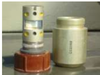
Рис. 5.7. Радіоізотопне градуйоване джерело:
