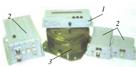
Рис. 4.43. Вимірювач потужності дози ИМД-23
