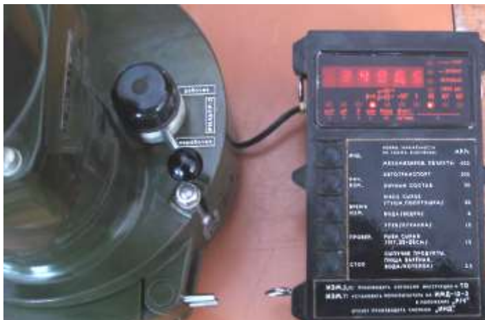
Рис. 4.23. Перше вимірювання ( \beta+\gamma ) 3496,5 імп/с
