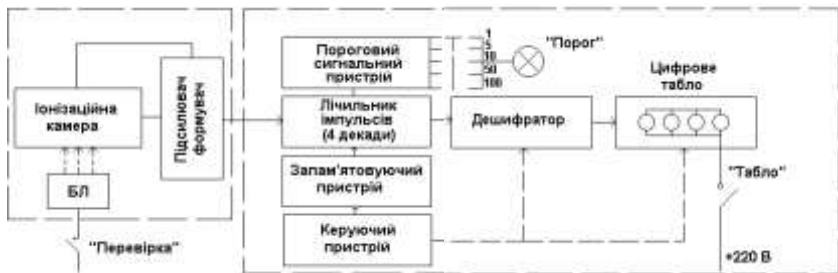
Рис. 3.68. Структурна схема приладу ИМД-21Б
