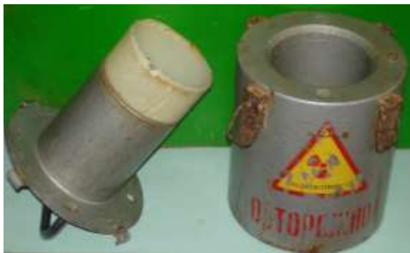
Рис. 5.8. Джерело гамма-випромінювання (ГС 7.012.6) приладу РАП-1 та його місцевий захист
