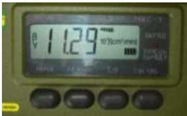
Рис. 3.58. Вимірювання щільності потоку бета-частинок
