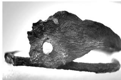
Рис. В.16. Сліди деформації металу на поверхні
