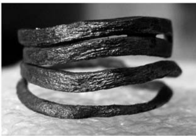
Рис. В.16. Сліди деформації металу на поверхні
