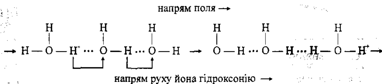
Рис. 11.6. Схема руху йона гідроксонію
