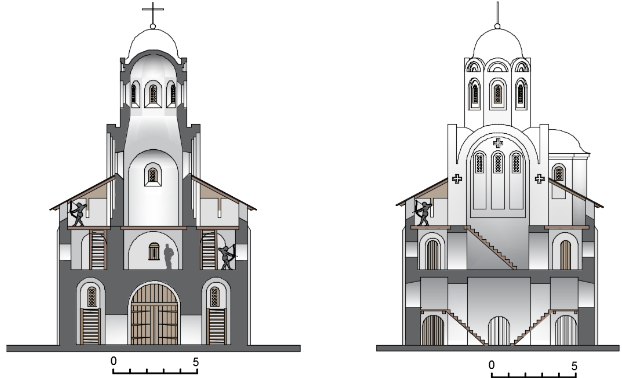
Рис. 32. Гіпотетична реконструкція поперечного розрізу Троїцької церкви і проїзної брами Печерського монастиря у XII ст. Реконструкція В. І. Лук'яненка
