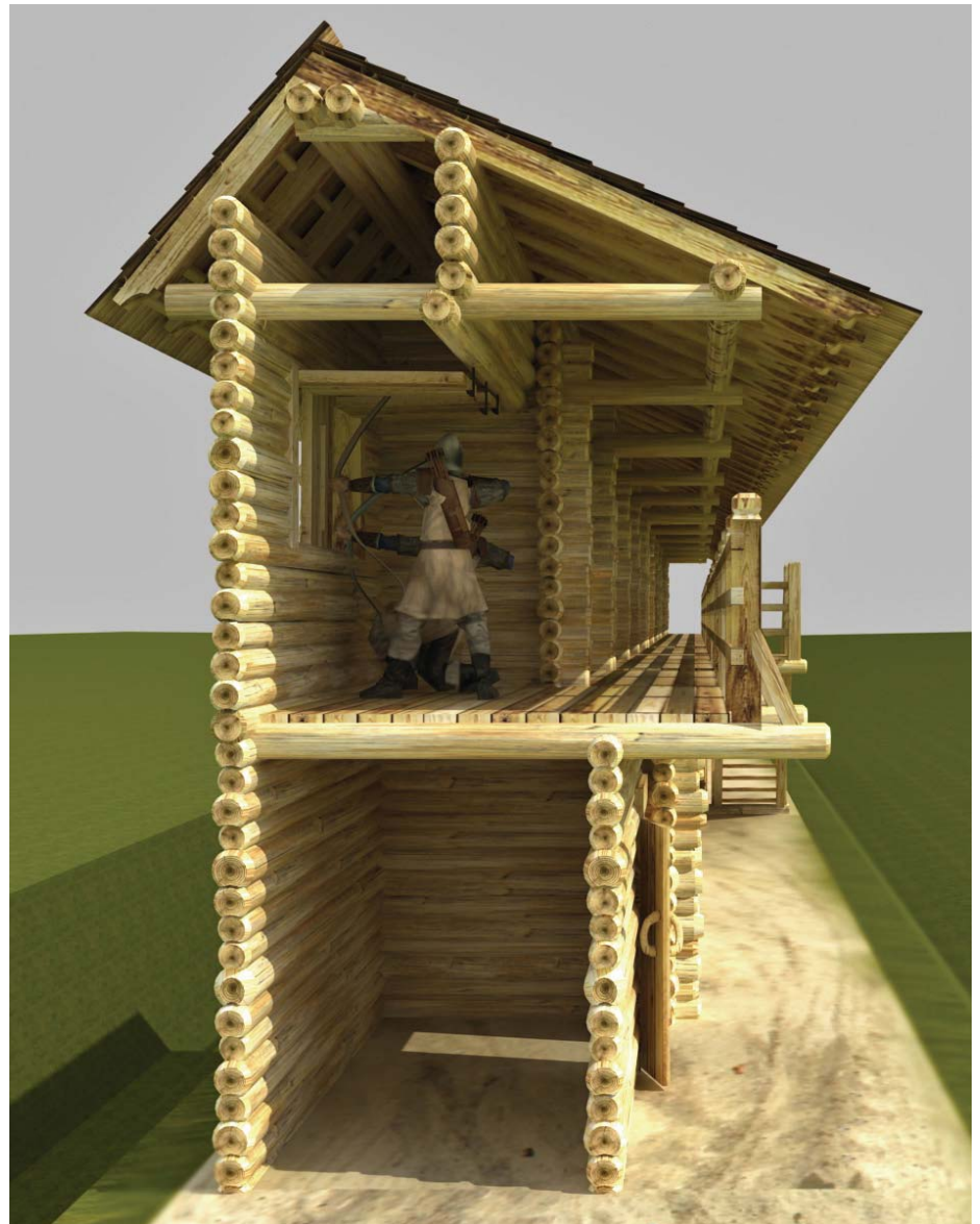
Ил.19. Реконструкция двухъярусного укрепления. Поперечный разрез. Первый ярус – четырехстенные городни. Во втором ярусе заборала без подсыхания.
