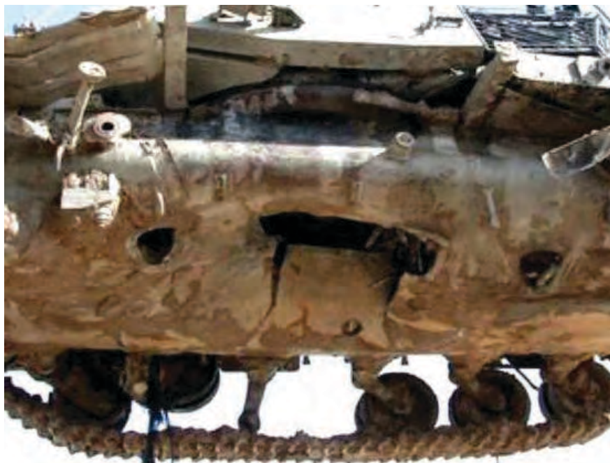
Їзраїльський танк Magach-7 з пробою від міни TM-72, Південний Ліван
