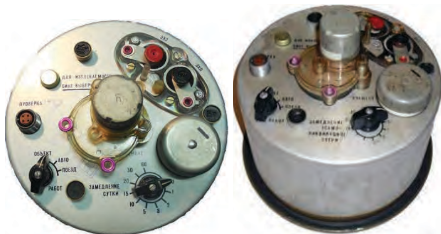
Малюнок 10.1.2 - Підривач ВМЗУ міни МЗУ (зліва), та ВМЗУ-С міни МЗУ-С
