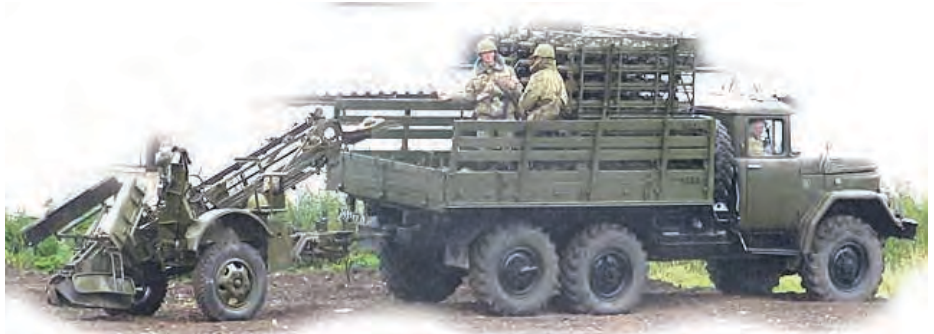
Малюнок 15.3.1 – Мінний загороджувач ПМЗ-4П, причеплений до ЗІЛ-131
