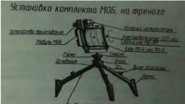
Малюнок 7.7.2 – Установка міни МОБ на тринозі (з інструкції з експлуатації АО НИИИ та МО РФ); потужність приблизно як у МОН-50
