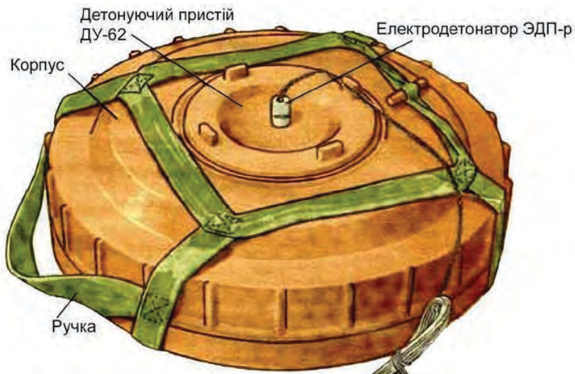
Малюнок 1.6.2 – Міна ТМ-62П з електродетонатором ЭДП-р, та детонуючим пристроєм ДУ-62
