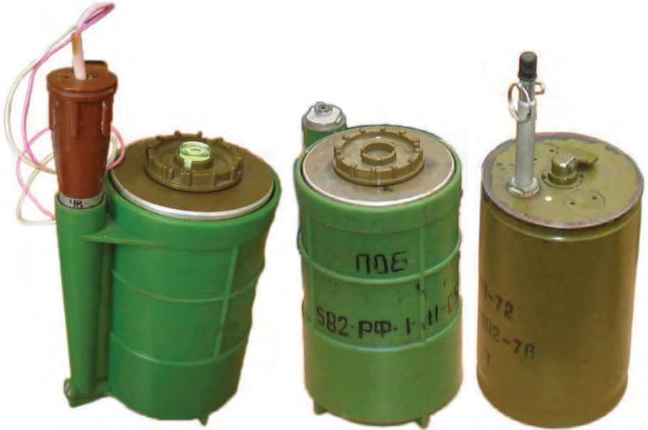
Малюнок 6.9.1 – Міна ПОВ, з електронакольним механізмом НМ – зліва; Міна ПОВ без детонатора – в центрі; в порівнянні з міною ОЗМ-72, справа
