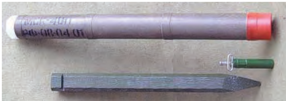
Малюнок 13.2.1 – Міна МСК-40П, детонатор МУВ та дерев'яний кілок
