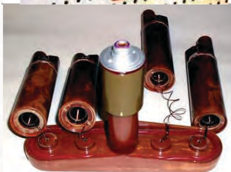
Малюнок 12.1.4 – ЗМГ з ВУЗ-4, схема (зліва); ВУЗ-4 в зборі (справа-знизу) та з МУВ (зверху-справа); Цифрами зазначено: 1 – ЗМГ; 2 – електро-механічний пристрій на настановній планці; 3 – накольні механізми ВУЗ-4 з саперним дротом; 4 – піротехнічний сповільнювач
