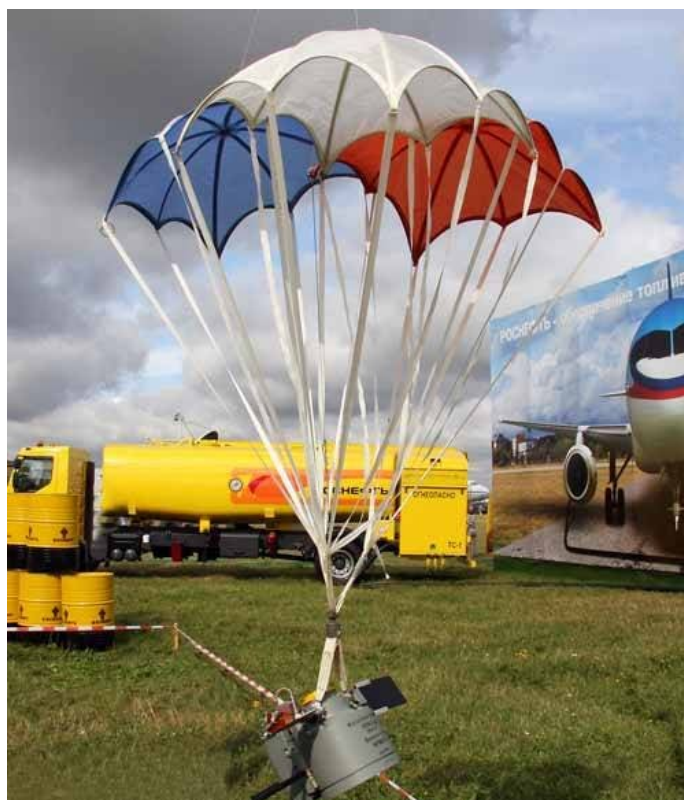
Елемент СПБЕ в конфігурації спуску та прицілювання
