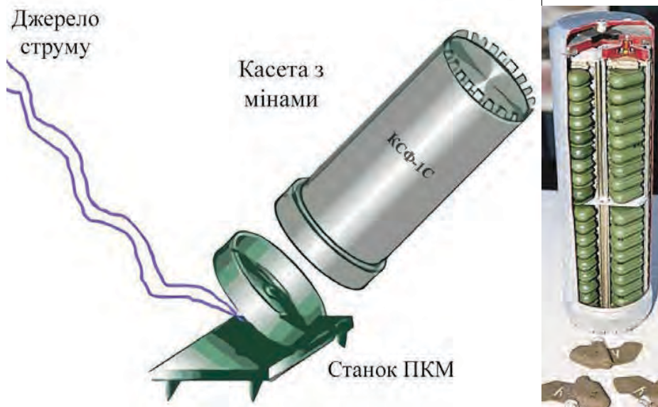
Малюнок 5.6.2 – Касета КСФ-1С: схема та розріз
