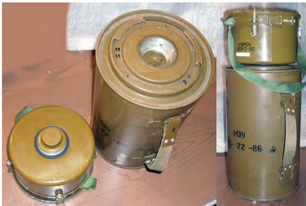
Міна МЗС в розібраному та зібраному стані
