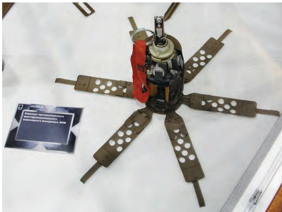
Малюнок 6.10.3 – Міна-граната МІБ, в бойовому положенні
