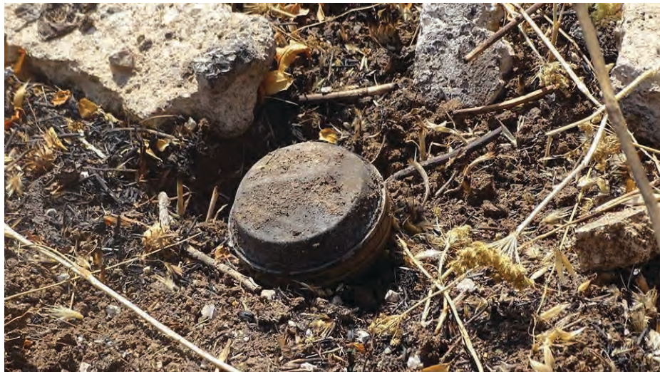
Малюнок 5.5.2 – Міна ПМН-4 в ґрунті. Вона дуже мала і її важко виявити
