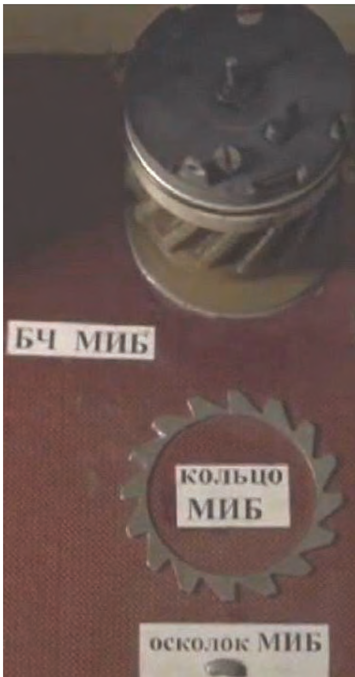
Малюнок 6.10.2 - Сталеві кільця МІБ, з яких , при підриві утворюються уламки
