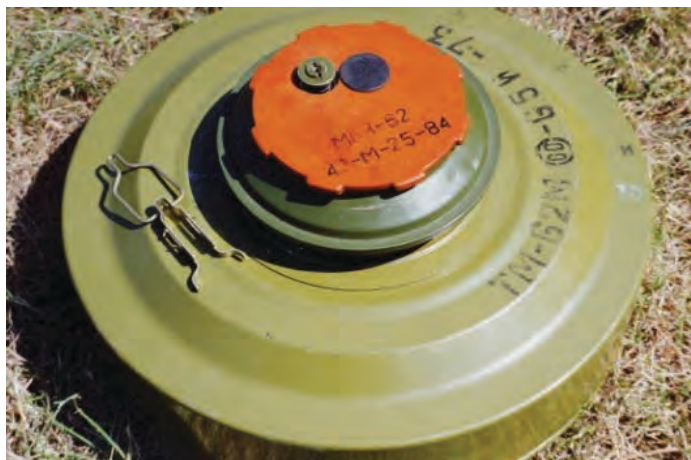
Малюнок 1.4.1 - Міна ТМ-62М з підривачом МВЧ-62
