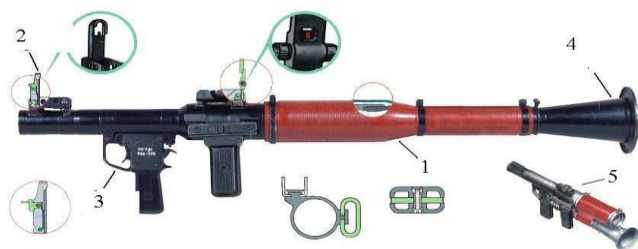
Рисунок 10.6 – Основні частини і механізми РПГ-7: 1 – труба; 2 – механічний (відкритий) приціл; 3 – ударно-спусковий механізм; 4 – розтруб; 5 – РПГ-7Д складений
