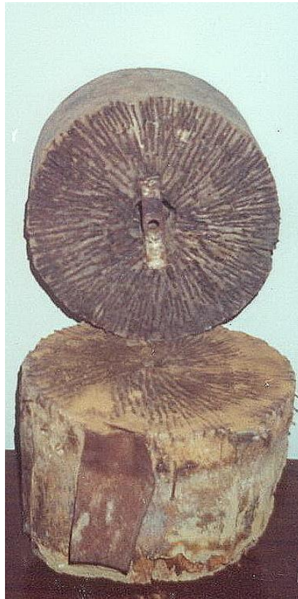
16. Жорна, виготовлені з дерев'яних колод. Село Баштанків. Кодимський район. Фото автора.
