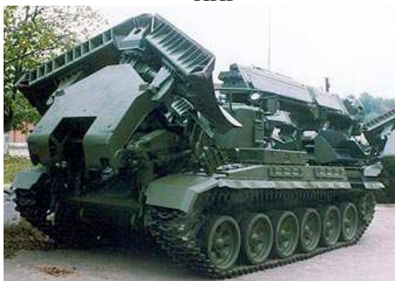
Фото. Б.17. Інженерна машина розгородження ИМР-2 3
