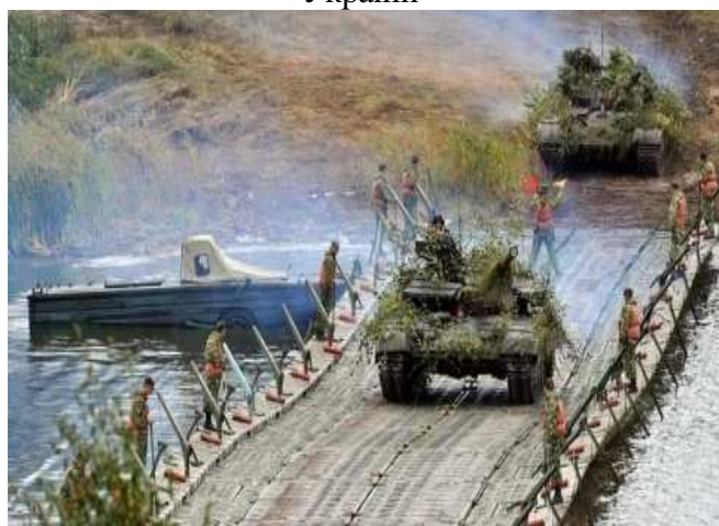
Фото. 3.6. Обладнання переправ. Понтонно-мостовий парк ПМП
