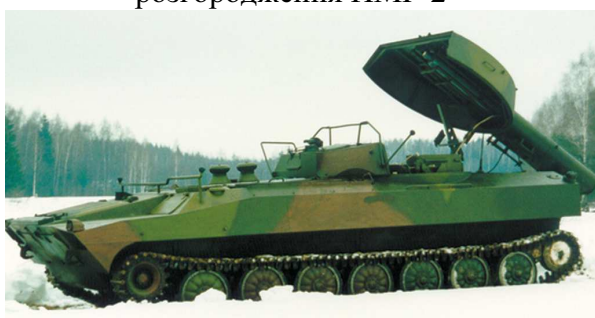
Фото. Б.19. Установка розмінування УР-77 5
