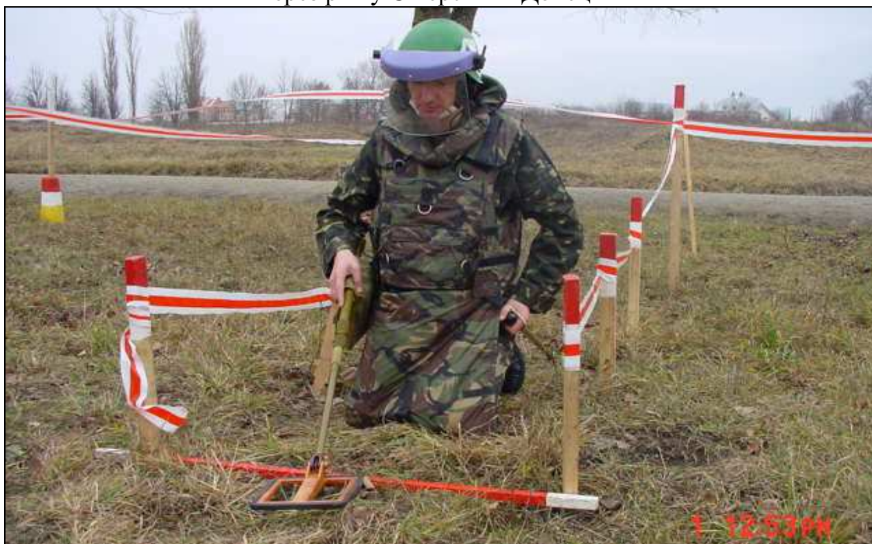
Фото. 3.9. Маркування розмінованих проходів в районі проведення АТО 2
