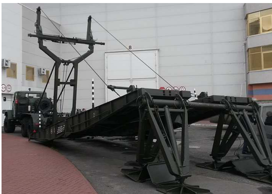
Фото. Б.21. Важкий механізований міст ТММ-3М 1
