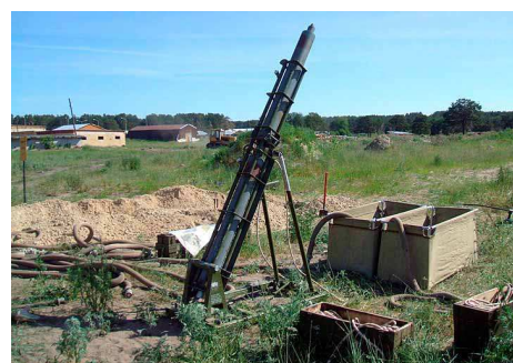
Фото. Б.20. Установка розмінування УР-83П
