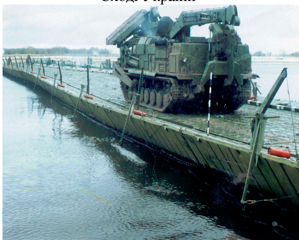
Фото. 3.5. Обладнання переправ. Понтонно-мостовий парк ПМП
